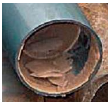
Figura 2.7 - Incrustação em condutas de PVC © ALEGRE, et al., (2010)
