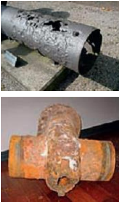
Figura 2.8 - Condução furada e válvula degradada, por efeito da corrosão © ALEGRE, et al., (2010)
