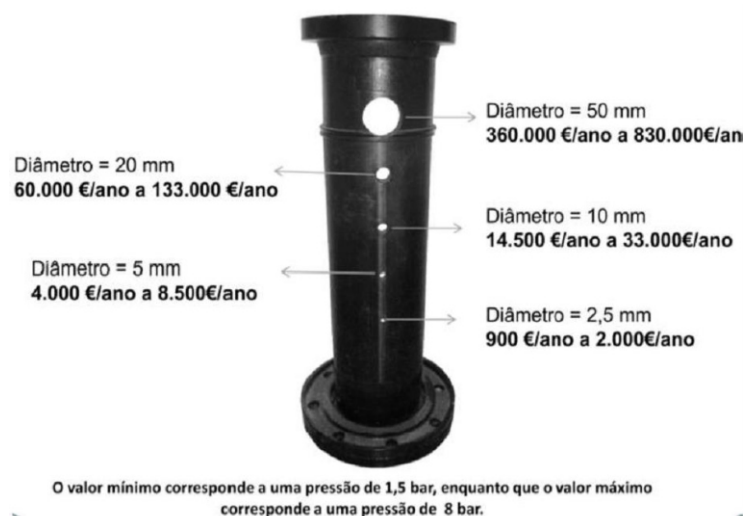
Figura 2.6 - Variação do custo anual das perdas reais, em função do diâmetro do orifício. © EMARP (2014)
