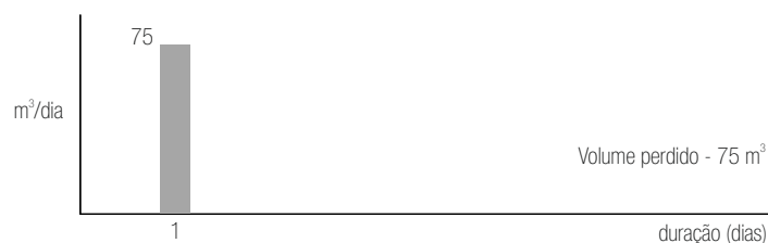
Figura 2.2 - Relação entre o volume de água perdido e a duração da fuga através de uma rotura de fácil deteção. Adaptado de FARLEY, et al., (2008)
