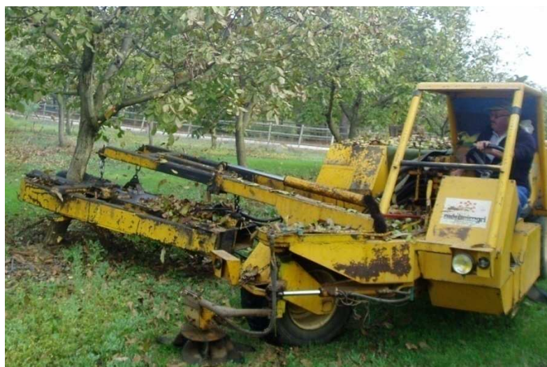
Figura 37 – Pinça descentrada fixa no tronco da árvore
