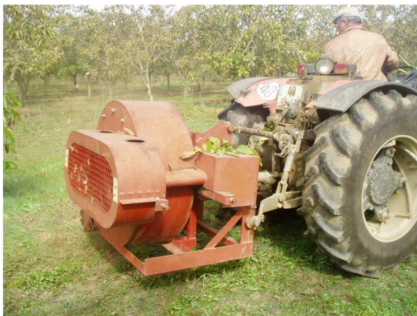
Figura 38 – Aspeto do ventilador montado no sistema de engate de três pontos do tractor
