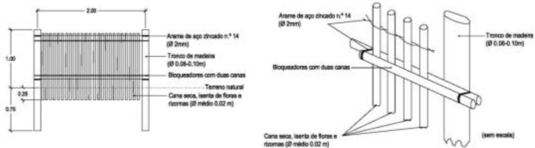
Figura 26 – Esquema de construção das barreiras ou vedações difusas
