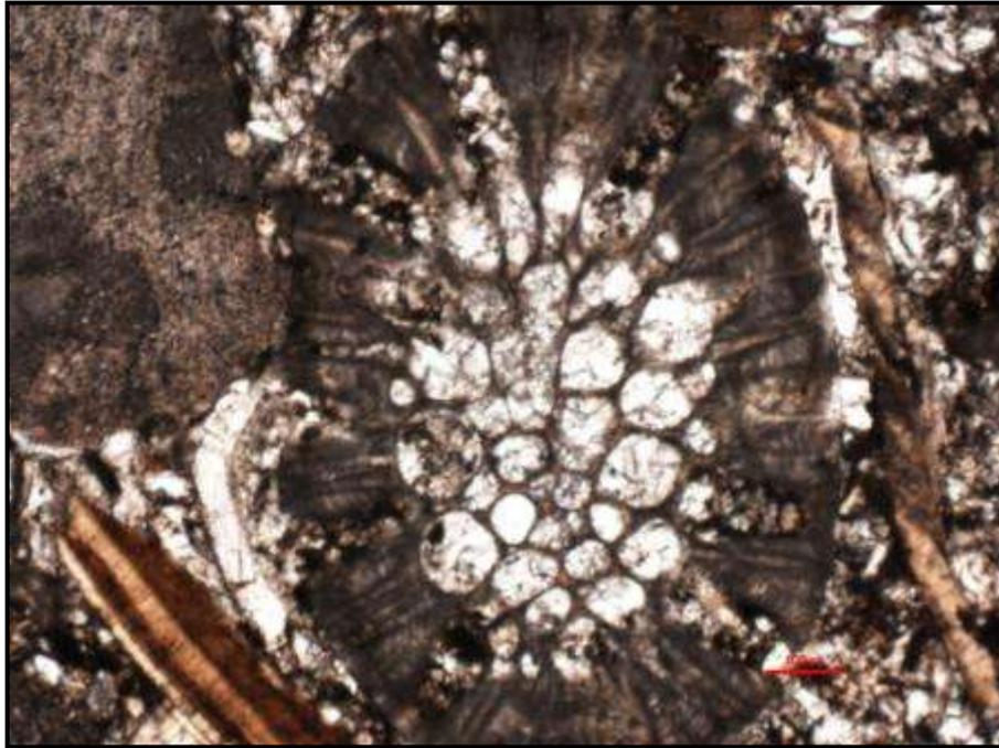
Figura 4. 32. Fotografia da lâmina delgada de calcarenito. Fotografia tirada com nicóis paralelos (utilizei LU Plan Fluor 5X/0.15), a escala da fotografia 1 px = 1,4  $\mu$ m.
