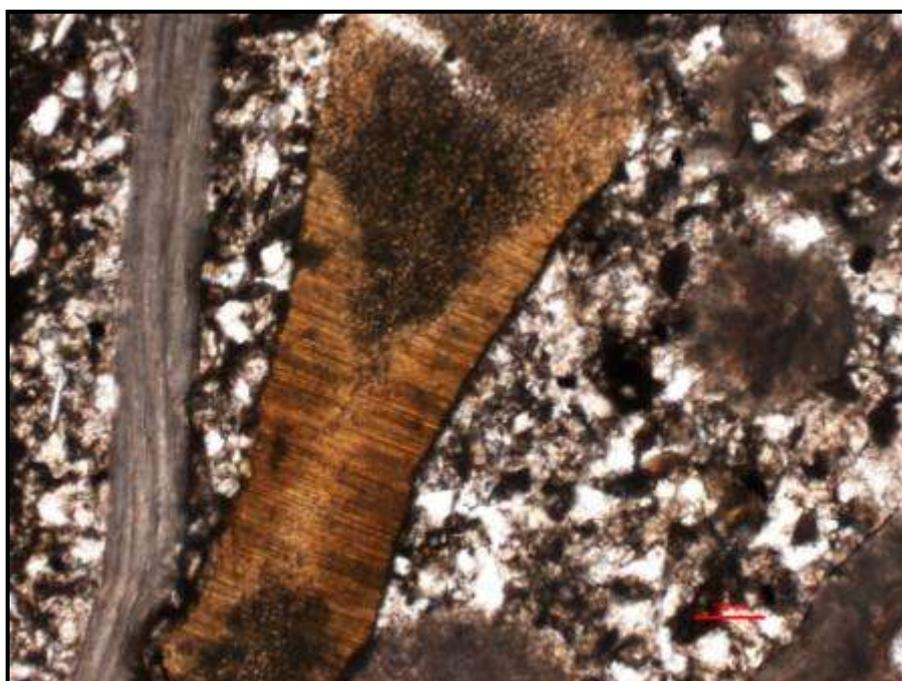
Figura 4. 30. Fotografia da lâmina delgada de calcarenito. A fotografia foi tirada com nicóis paralelos (utilizei LU Plan Fluor 5X/0.15), a escala da fotografia 1 px = 1,4 µm.
