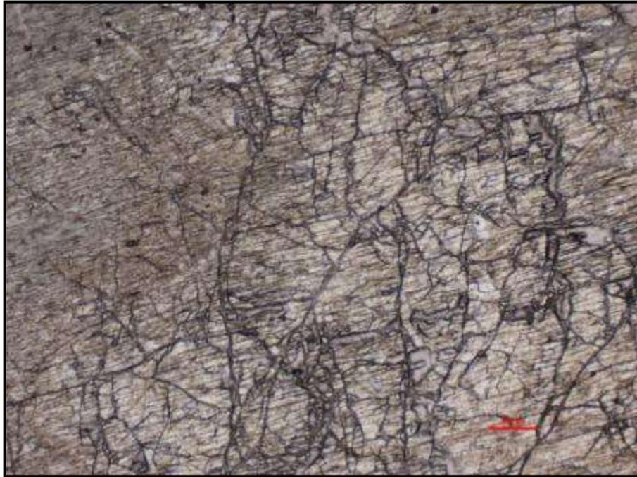
Figura 4. 22. Fotografia da lâmina delgada do gabro. A figura mostra um mineral de Piroxena com uma clivagem muito forte, a fotografia foi tirada com nicóis paralelos (utilizei LU Plan Fluor 5X/0.15), a escala da fotografia 1 px = 1,4  $\mu\text{m}$ .
