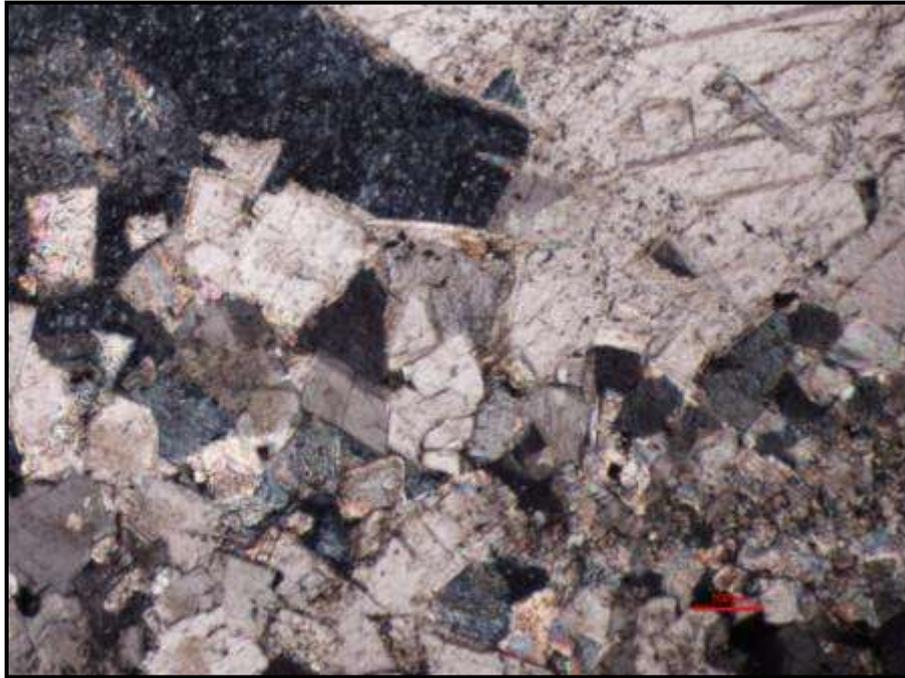
Figura 4. 27. Mesma imagem da figura anterior. Fotografia tirada com nicóis cruzados (utilizei LU Plan Fluor 5X/0.15), a escala da fotografia 1 px = 1,4  $\mu$ m.
