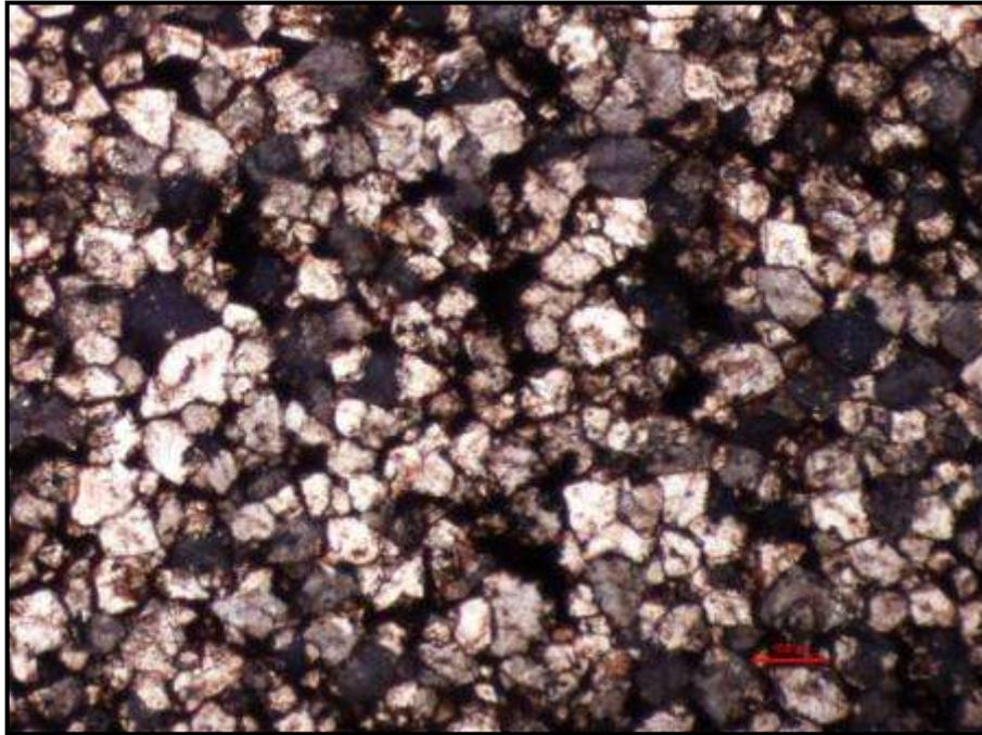
Figura 4. 25. Mesma imagem da figura anterior. A fotografia foi tirada com nicóis cruzados (utilizei LU Plan Fluor 5X/0.15), a escala da fotografia 1 px = 1,4  $\mu\text{m}$ .
