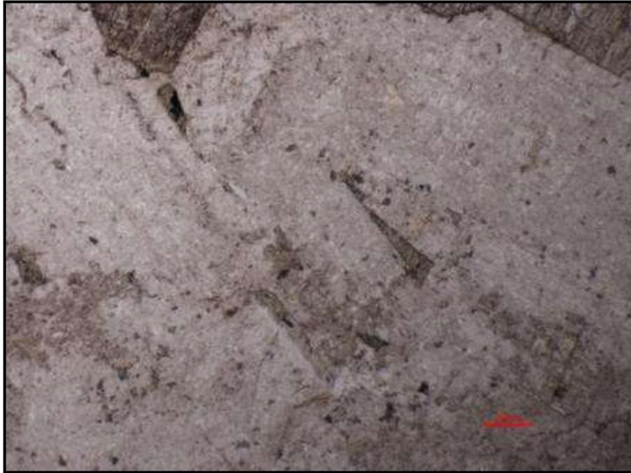
Figura 4. 20. Fotografia da lâmina delgada de um gabro. A figura mostra o mineral de Plagioclase, a fotografia foi tirada com nicóis paralelos (utilizei LU Plan Fluor 5X/0.15), a escala da fotografia 1 px = 1,4  $\mu\text{m}$ .
