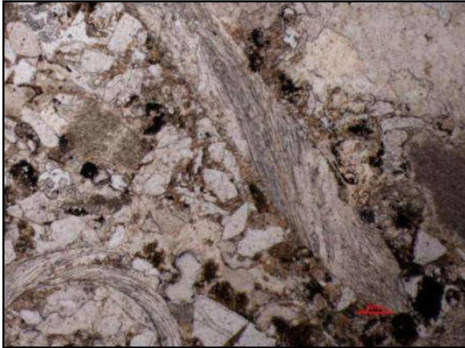
Figura 4. 28. Fotografia da lâmina delgada de um biocalcarenito. A figura mostra os minerais de um calcarenito bioclástico com fragmentos da concha. Fotografia tirada com nicóis paralelos (utilizei LU Plan Fluor 5X/0.15), a escala da fotografia 1 px = 1,4  $\mu\text{m}$ .
