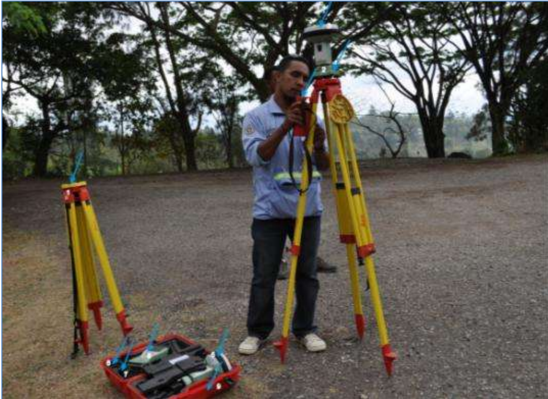
Fig. 32 Material GPS diferencial
