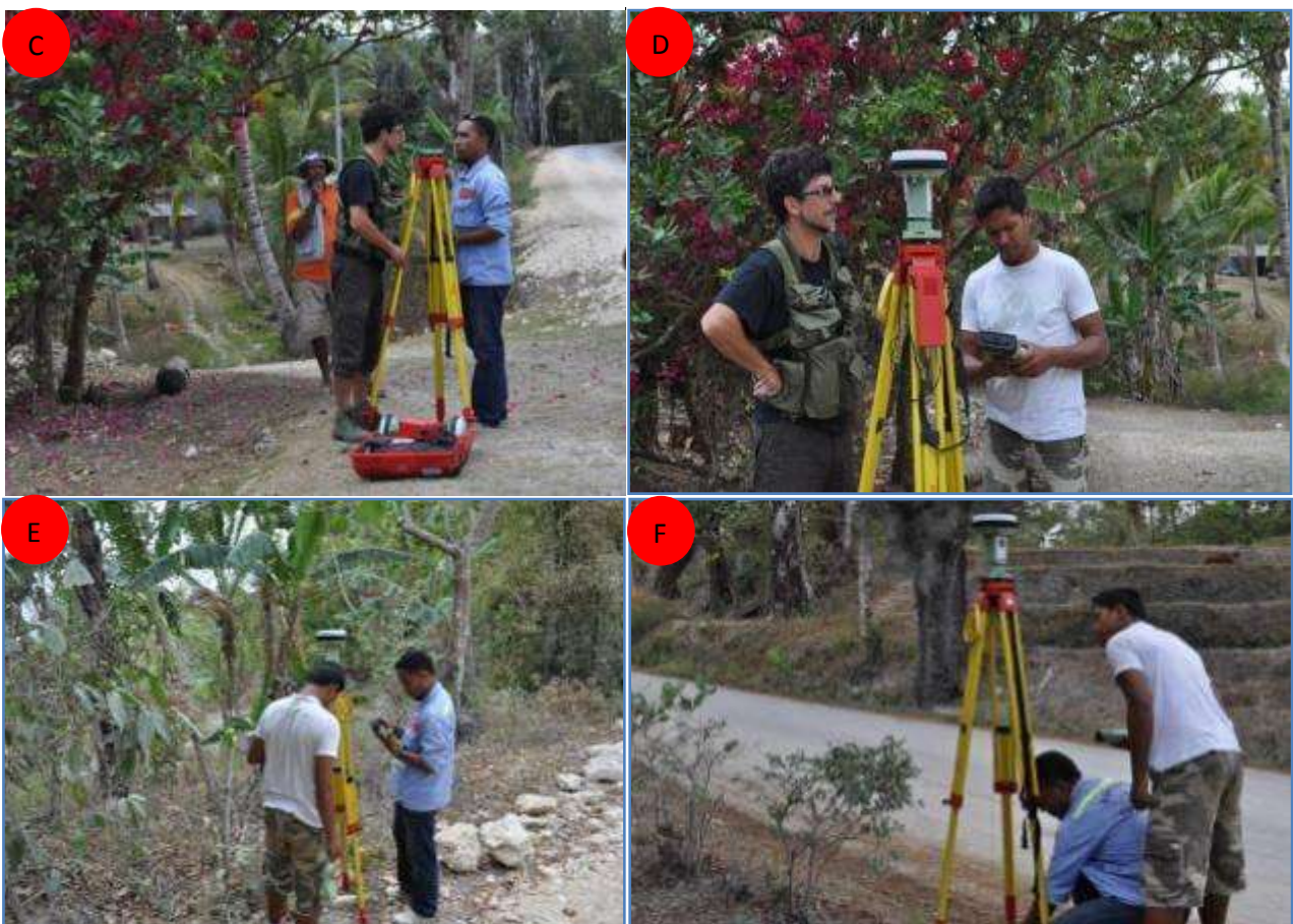
Figura 31 b . (C) Base de Tripe Monitorização Estrada em Venilale (D) Base de Monitorização (E) Pontos Monitorização (F) Medição de Altura Monitorização.
