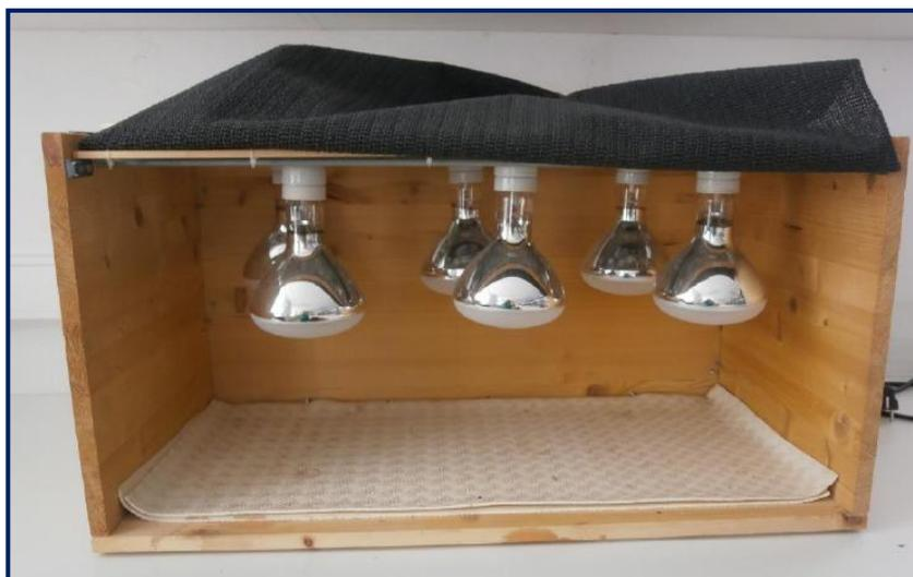
Figura 3.9: Câmara de radiação ultravioleta (UV) do Laboratório de Biogeoquímica Ambiental da Universidade de Évora.
