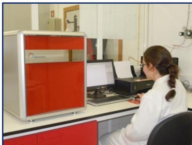
Figura 3.10: Analisador elementar no Laboratório de Biogeoquímica Ambiental da Universidade de Évora.
