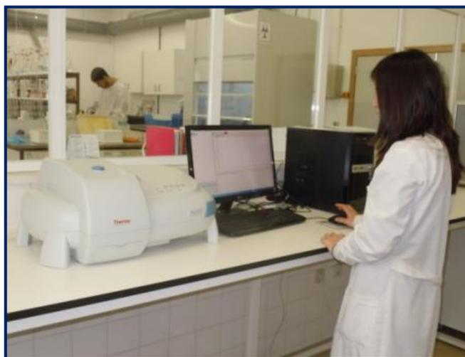
Figura 3.11: Espectrómetro de absorção molecular UV/Visível do Laboratório de Biogeoquímica Ambiental da Universidade de Évora.
