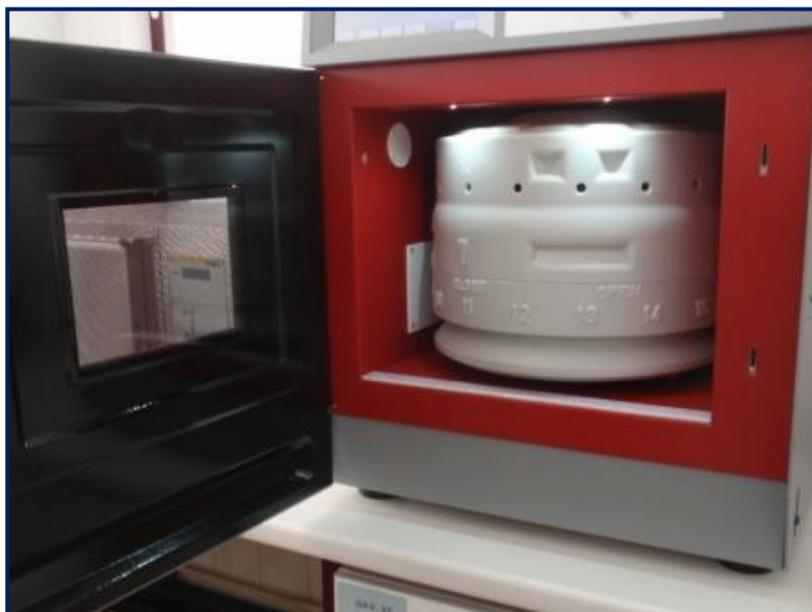
Figura 3.7: Digestor de microondas de alta pressão no Laboratório de Biogeoquímica Ambiental da Universidade de Évora.
