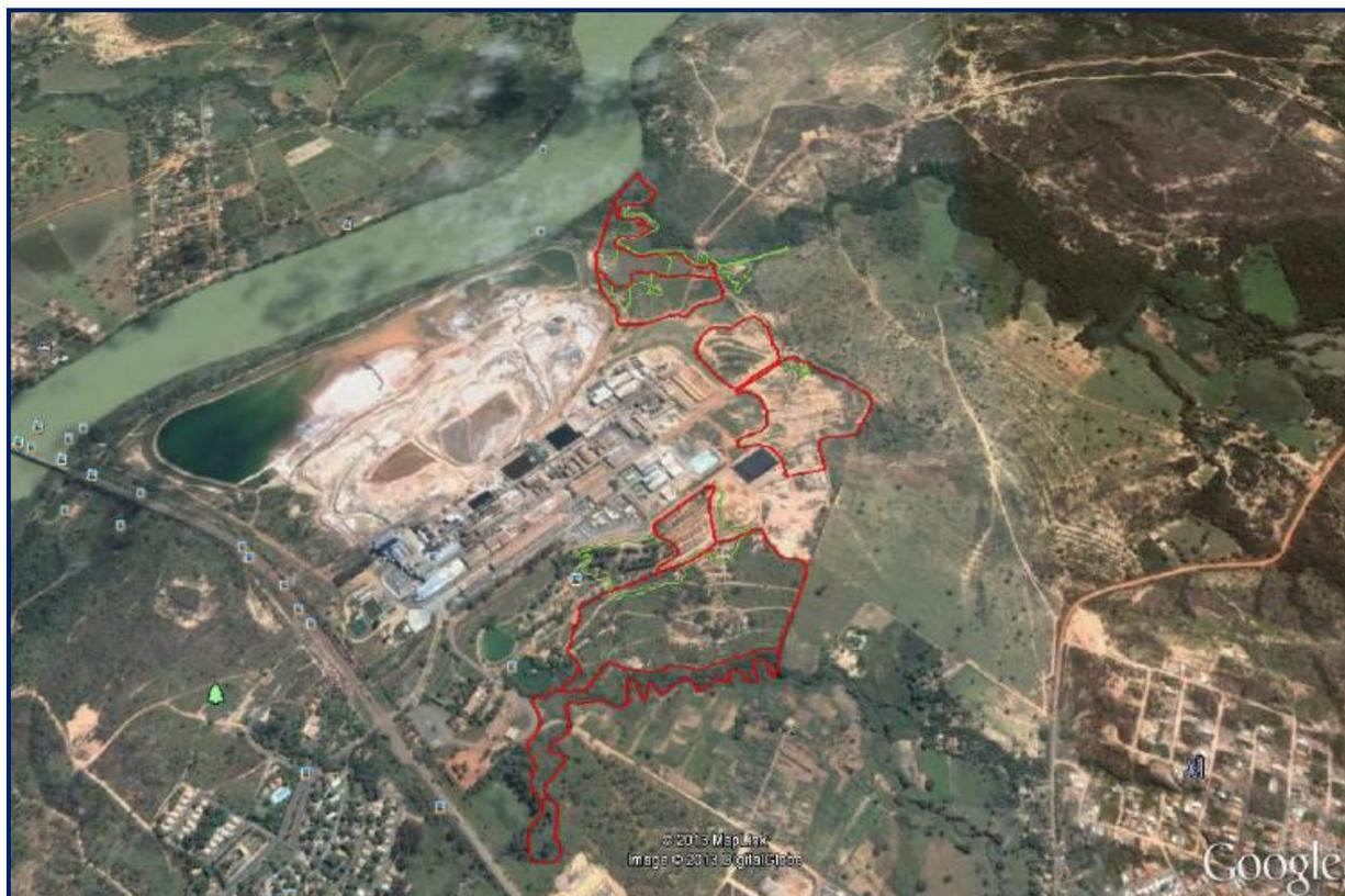
Figura 3.1: Delimitação das áreas contaminadas (a verde) e degradadas (a vermelho) na área industrial da Votorantim Metais. Adaptado de *Golder Associates* (2007b).
