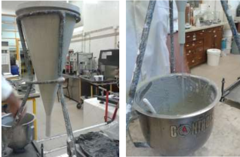
Figura 9: Ensaio de Escoamento
