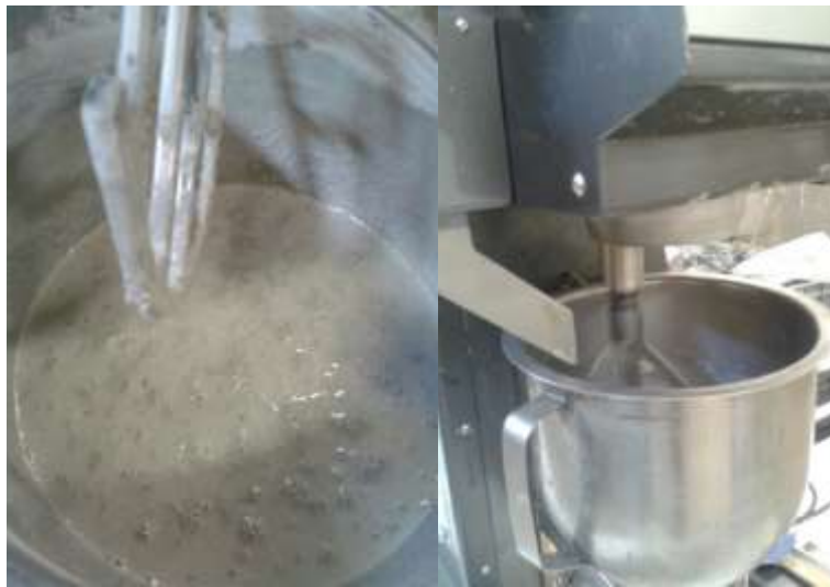
Figura 5: Procedimento de amassadura de uma argamassa
