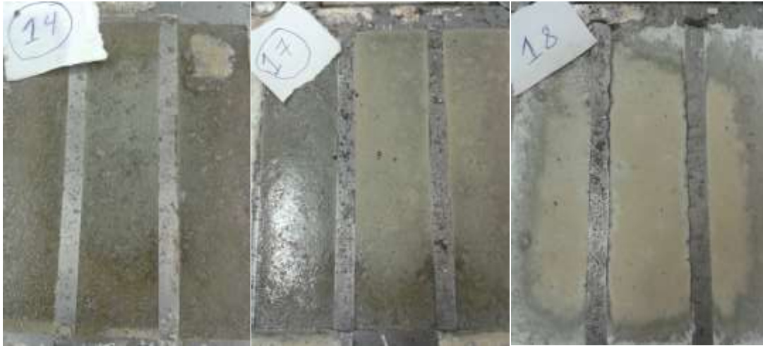
Figura 10: Argamassas no estado seco antes de se proceder à desmoldagem
