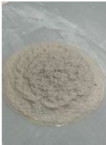
Figura 8: Ensaio de espalhamento da argamassa com maior consistência
