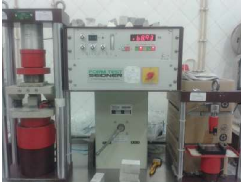
Figura 11: Equipamento de ensaios à resistência à flexão e à compressão
