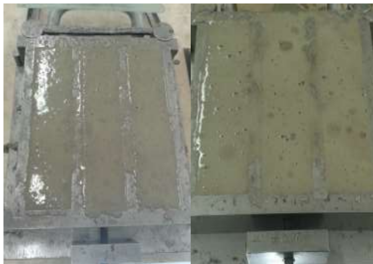
Figura 6: Moldagem da argamassa no estado fresco
