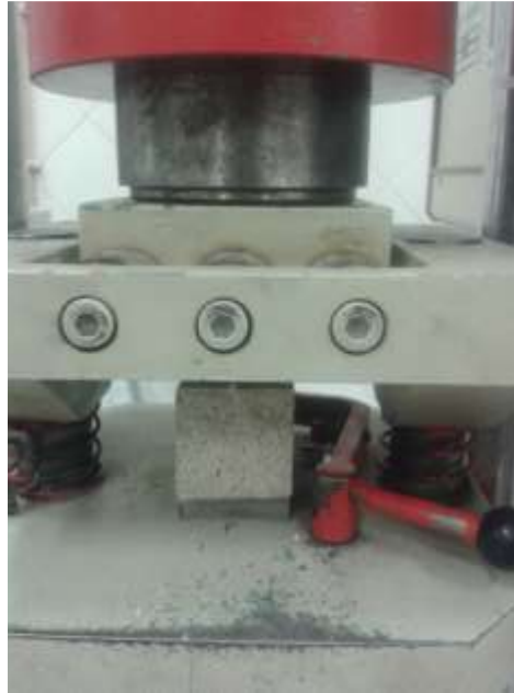
Figura 15: Início do ensaio de resistência à compressão
