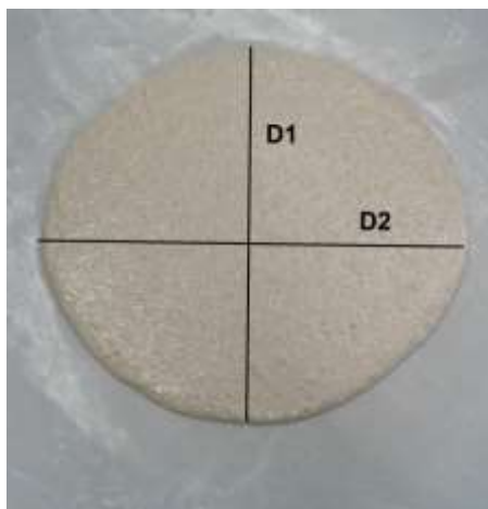
Figura 7: Medição do espalhamento da amassadura 12
