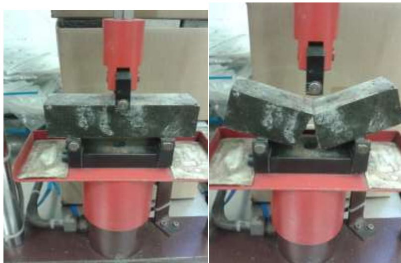
Figura 13: Ensaio à flexão, antes e depois da força aplicada.
