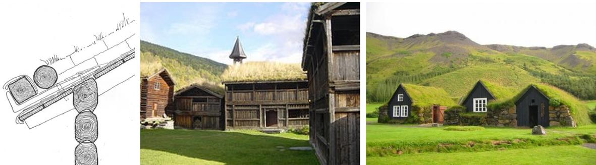
Fig. 47, 48 e 49 – Pormenor da construção de um Sod Roof (à esquerda). Sod roofs numa quinta em Gudbrandsdal, Noruega (ao centro). Fonte: <[http://en.wikipedia.org/wiki/Sod\\_roof](http://en.wikipedia.org/wiki/Sod_roof)>; Sod Roof na escandinávia (à direita). Fonte: <<https://picasaweb.google.com>>
