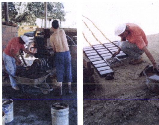
Fig. 4.279 – A massa (argila, água, e pó de pedra) é misturada com máquina eléctrica apropriada (foto da autora)
