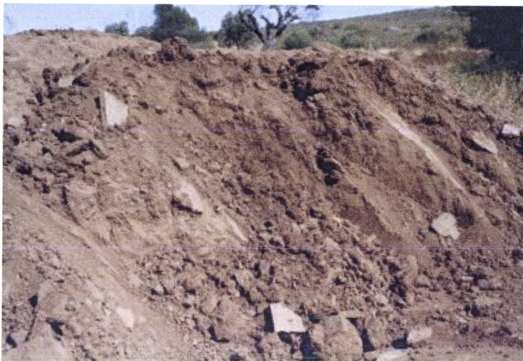
Fig. 4.278 - Argila – matéria prima utilizada no fabrico de tijolo maciço ( foto da autora)
