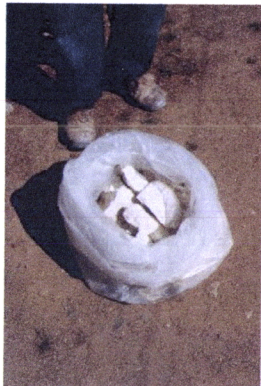
Fig. 4.334 – Processo de hidratação da cal viva, cal ensacada a fim de evitar a sua alteração pela entrada de ar ou humidade (foto da autora)
