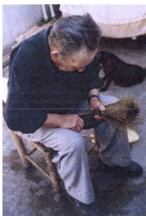
Fig. 4.351 e Fig. 4.352 – Idem , desmancho da vassoura e acerto da palma ( fotos da autora)
