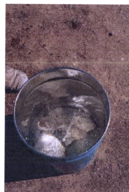
Fig. 4.334 – Processo de hidratação da cal viva, cal ensacada a fim de evitar a sua alteração pela entrada de ar ou humidade (foto da autora)
