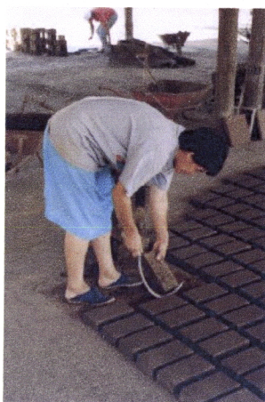
Fig. 4.285 – Retira-se o excesso de massa depois das peças estarem mais ou menos secas ( foto da autora) Fig. 4.286 – Forno apropriado para a cozedura do tijolo ( foto da autora)
