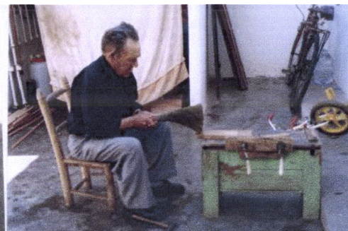
Fig. 4.349 e fig. 4.350 – Processo de execução do esfuminho, Improvisação de uma tábua de repar ( tábua com pregos pregados de modo a que as pontas estejam viradas para cima), e ripagem da palma da vassoura até se obter espessura mais fina. ( fotos da autora)
