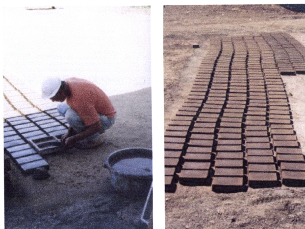
Fig. 4.283 – Posteriormente desenforma-se a peça ( foto da autora)
