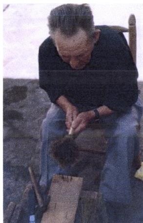
Fig. 4.349 e fig. 4.350 – Processo de execução do esfuminho, Improvisação de uma tábua de repar ( tábua com pregos pregados de modo a que as pontas estejam viradas para cima), e ripagem da palma da vassoura até se obter espessura mais fina. ( fotos da autora)
