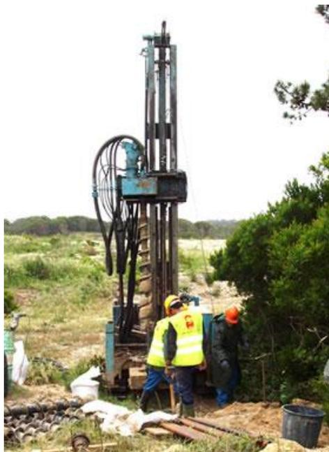
**Figura 7 – Execução de uma sondagem in situ - Sondagem a trado**
