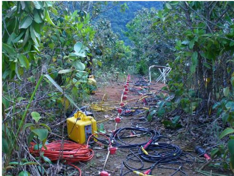
**Figura 8 – Execução de uma sondagem de refração sísmica.**
