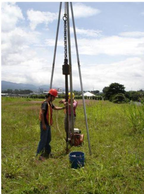
**Figura 6 – Execução de uma sondagem SPT**
