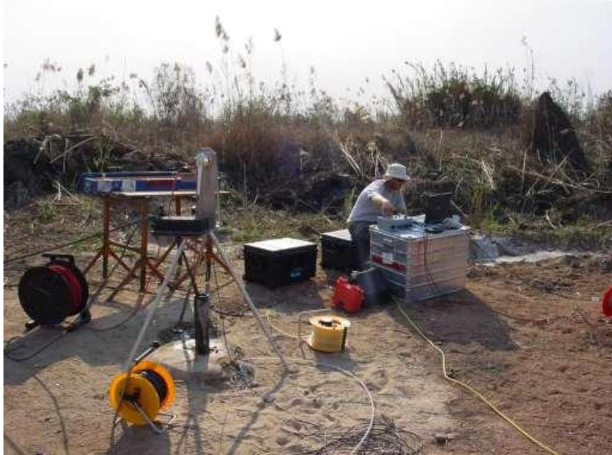
**Figura 9 – Execução de uma sondagem geofísica**
