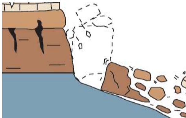
Fig: 3.4 Esquema do Tombamento de Cruden e Varnes (1996) adaptado por Highland e Bobrowsky (2008)
