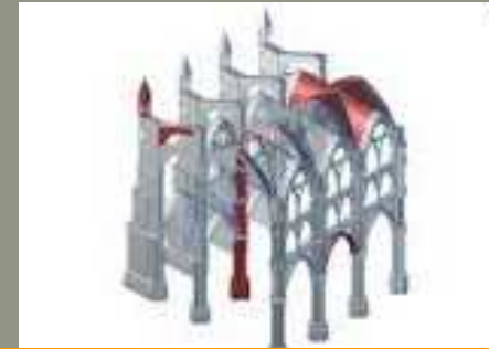
Contrafortes de igreja gótica, com abóbada de arestas.
