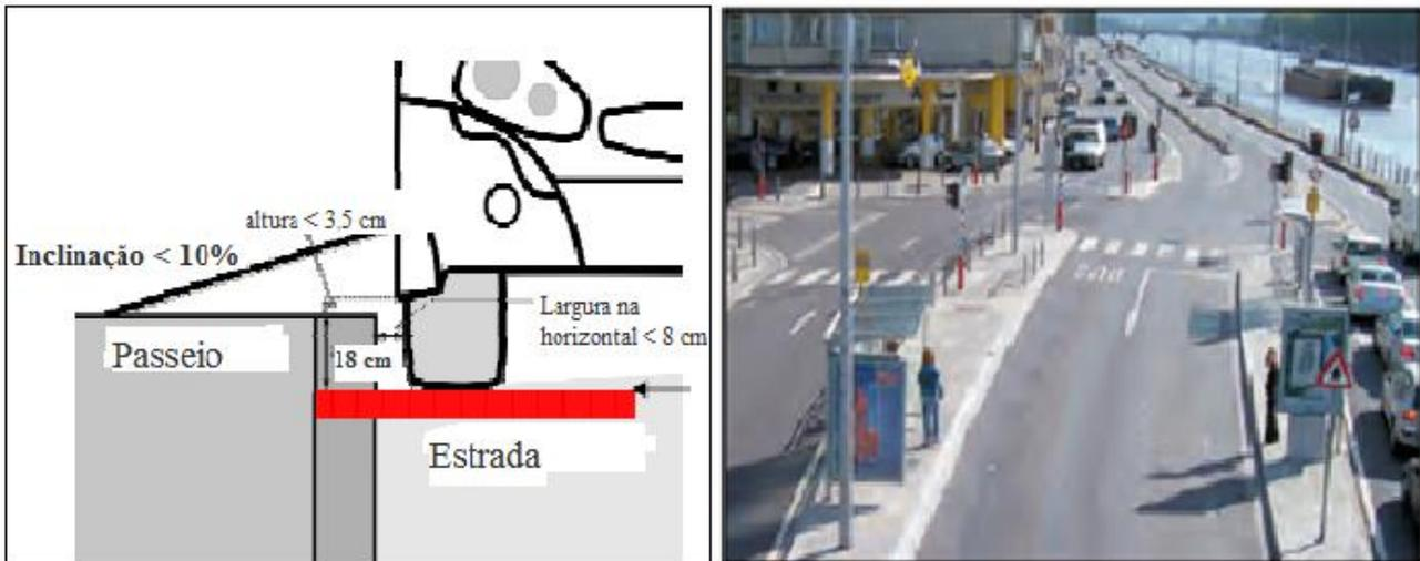
Figura 5.40: Configura o de paragem de autocarro acess vel na via p blica
