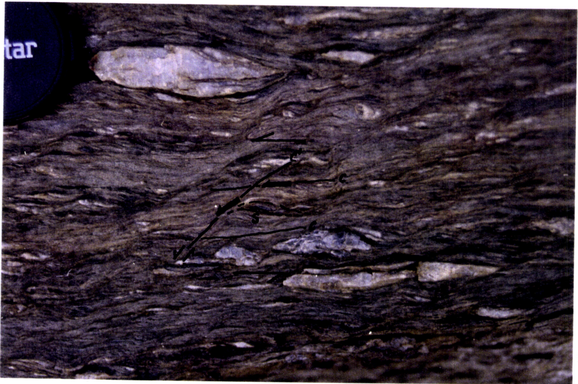
Estampa 16 - Fotografia com o desenvolvimento de Planos C + S, C' ("normal slip crenulations") em xistos sericíticos siliciosos (Formação de Mosteiros na Barragem do Caia)
