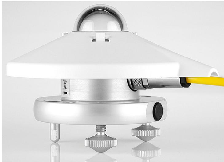
Figura 9 - Piranómetro CMP3 da Kipp & Zonen – Segunda Classe [13].
