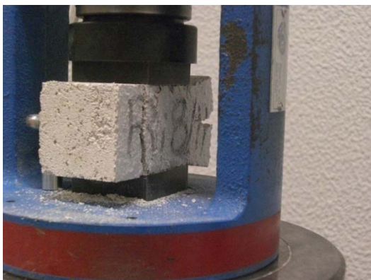
Figura 36: Determinação da resistência à compressão
