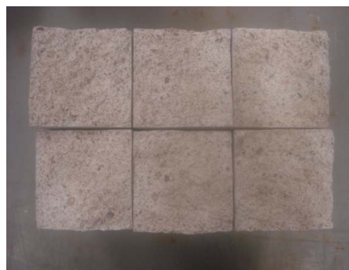
Figura 45: Apresentação da carbonatação das restantes argamassas aos 210 dias de idade
