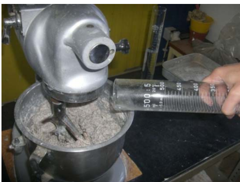
Figura 15: Junção de água na misturadora
