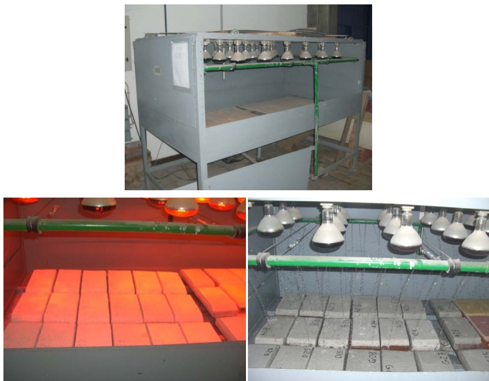
Figura 41: Câmara de envelhecimento e a decorrer a primeira etapa do primeiro e segundo ciclo do ensaio
