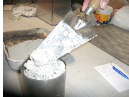
Figura 24: Enchimento do molde metálico
