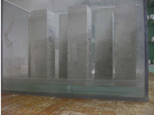
Figura 30: Ensaio de absorção de água por capilaridade
