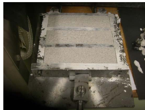
Figura 26: Molde prismático preenchido com a argamassa
