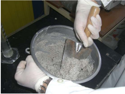
Figura 17: Raspagem das paredes e fundo da cuba com a pá de pedreiro
