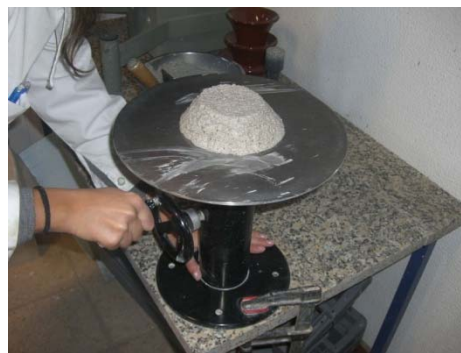
Figura 21: Ensaio da consistência por espalhamento
