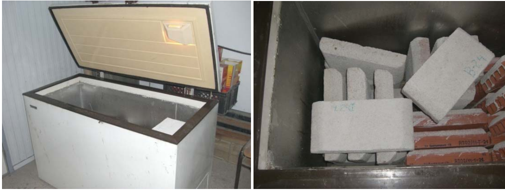
Figura 42: Arca frigorifica e a decorrer a segunda etapa do primeiro ciclo do ensaio
