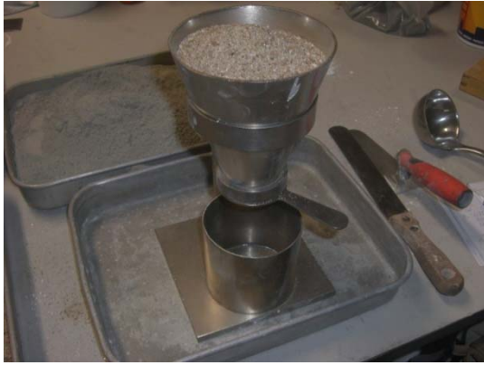
Figura 13: Início do ensaio da baridade da areia
