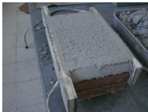
Figura 29: Molde em tijolo preenchido
