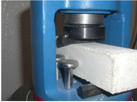
Figura 35: Determinação da resistência à flexão
