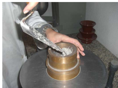
Figura 19: Inserção da argamassa no tronco-cónico
