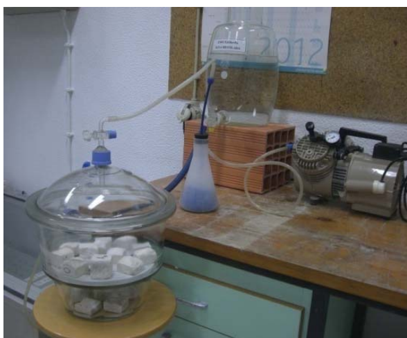
Figura 38: Decorrer do ensaio da porosidade aberta
