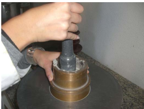
Figura 20: Compactação da argamassa
