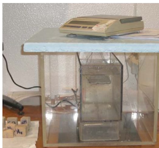
Figura 39: Pesagem submersa dos provetes
