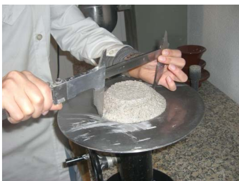
Figura 22: Medição da consistência por espalhamento
