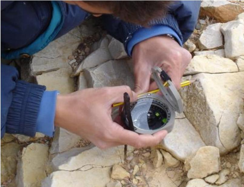
**Direcção : Ângulo formado por uma linha horizontal do plano de falha com a linha N-S (Mede-se com a bússola)**
