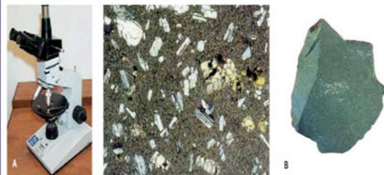
Fig. 7.6 Só com o microscópio petrográfico (A) é possível observar os minerais constituintes das rochas, mesmo quando não são bem visíveis à vista desarmada, como é o caso do andesito (B).
