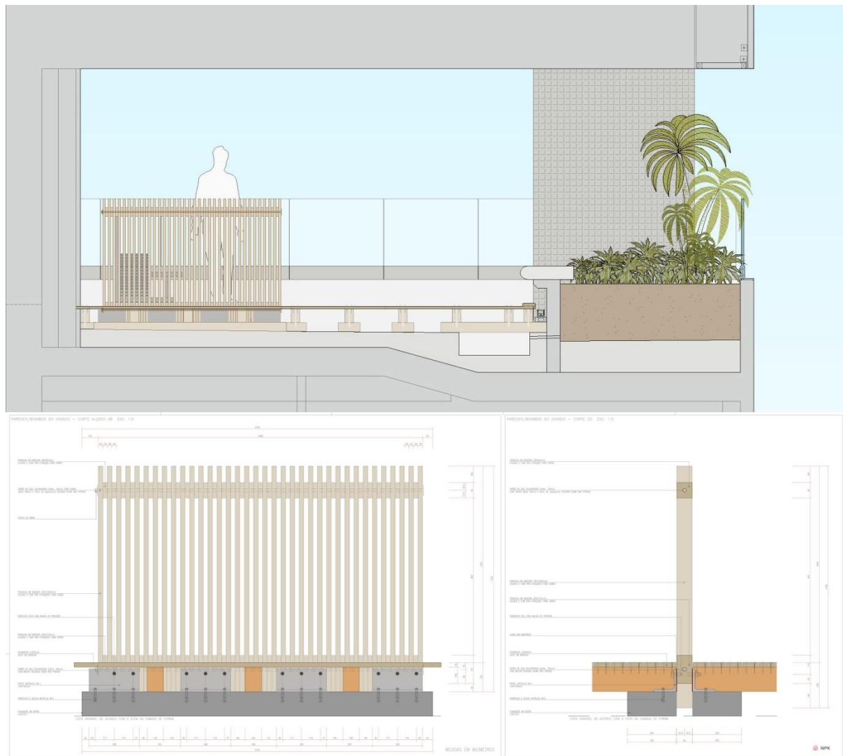
Figs. 8 e 9 – Corte relativo à área destinada à prática de actividades desportivas e pormenor construtivo dos biombos para aí propostos
