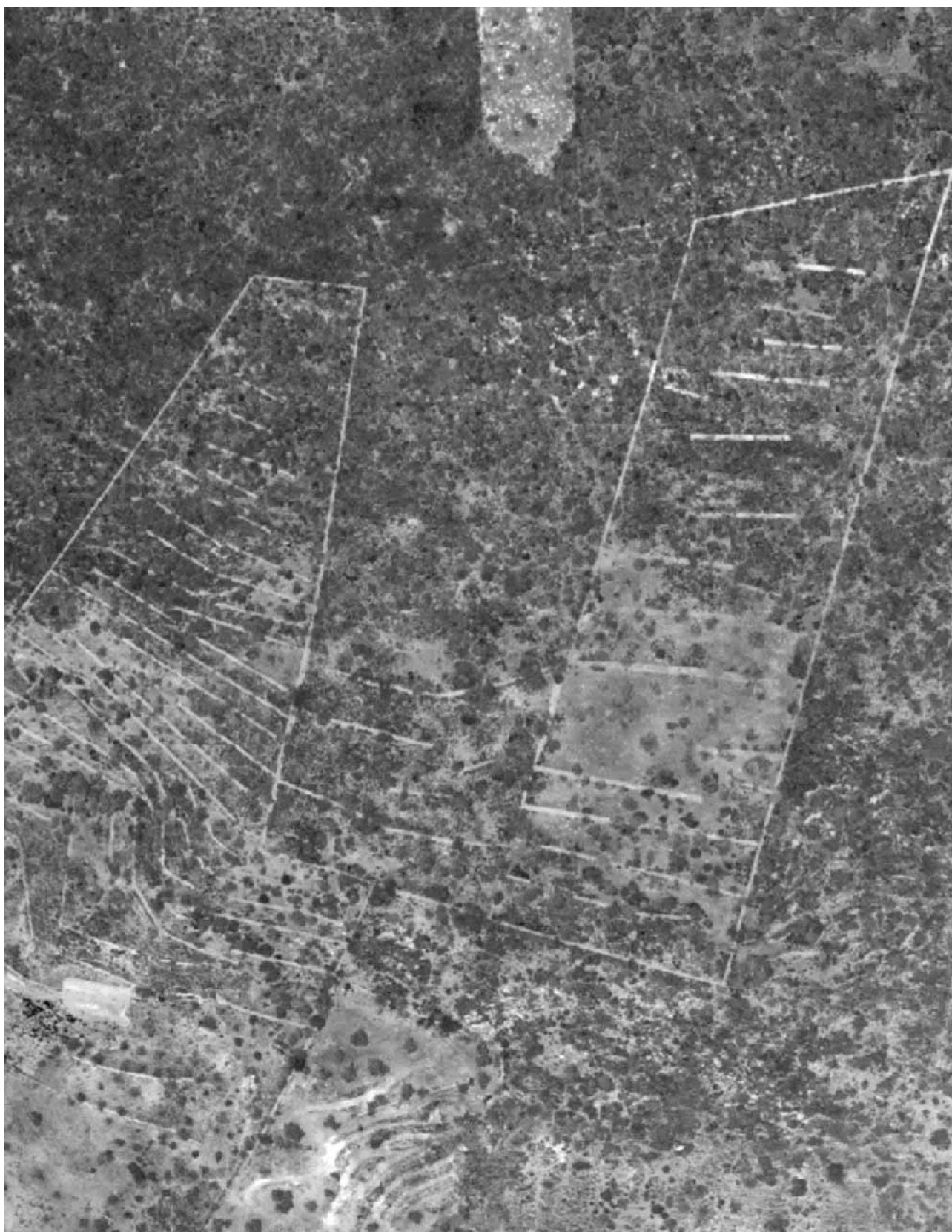
Ortofoto - Muros de limite e de suporte em encosta. Alte, Loulé. Algarve Digital, 2008.
