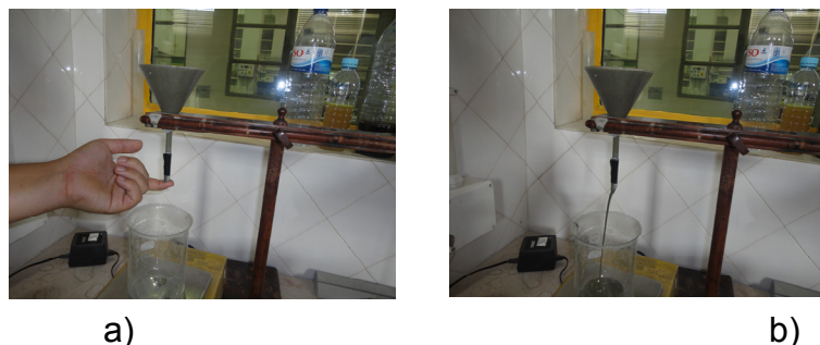
Figura 3.6 – Procedimento adotado para a execução do ensaio de escoamento.
