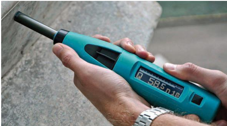
Figura 59: Com o valor da profundidade da carbonatação e com auxílio de um esclerômetro pode-se determinar a dureza à superfície do betão(40).
