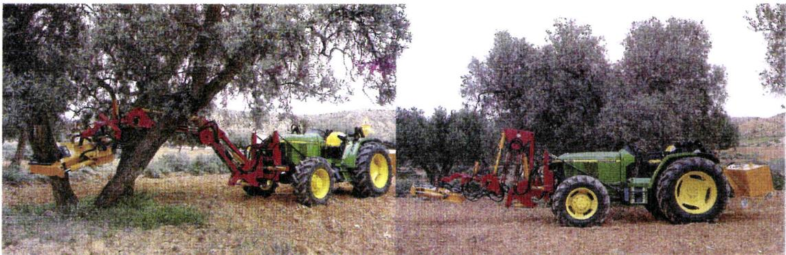
**Figura I-21** - Estrutura de suporte extensível. À esquerda, na configuração estendida, chegando ao tronco; à direita, na configuração recolhida.
