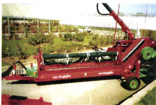
Figura I-37 - Semi-reboque específico para enrolador de panos.
