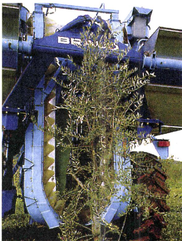
*Figura I-42 - Equipamento para colheita em olivais super-intensivos.
