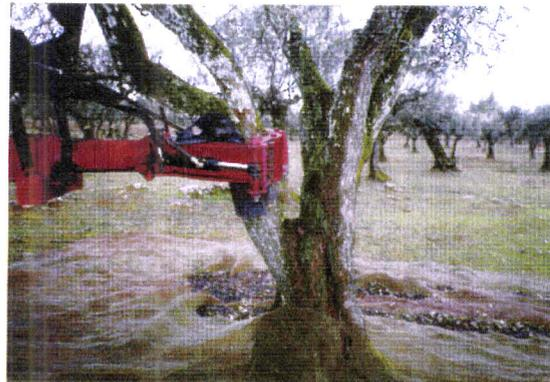
**Figura IV-16** - Pinça de vibrador.
