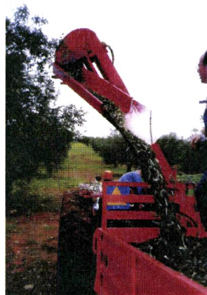
*Figura IV-24 - Enrolador de panos descarregando a azeitona para o semi-reboque.*
