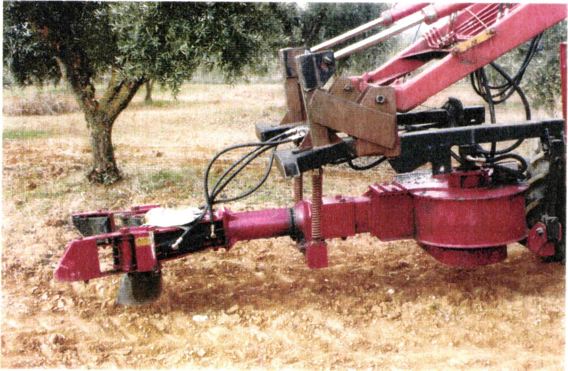
*Figura IV-12 - Vibrador utilizado nos ensaios, montado no carregador frontal do tractor.*
