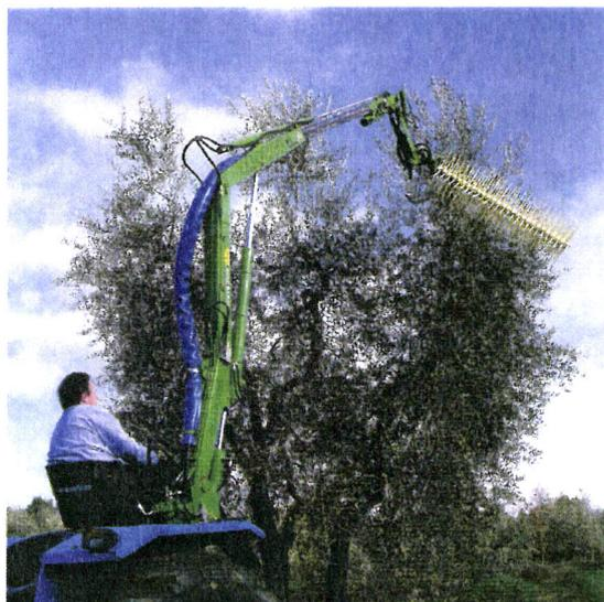
**Figura I-27** - Colheita mecânica por ação de um rotor munido de varas flexíveis.
