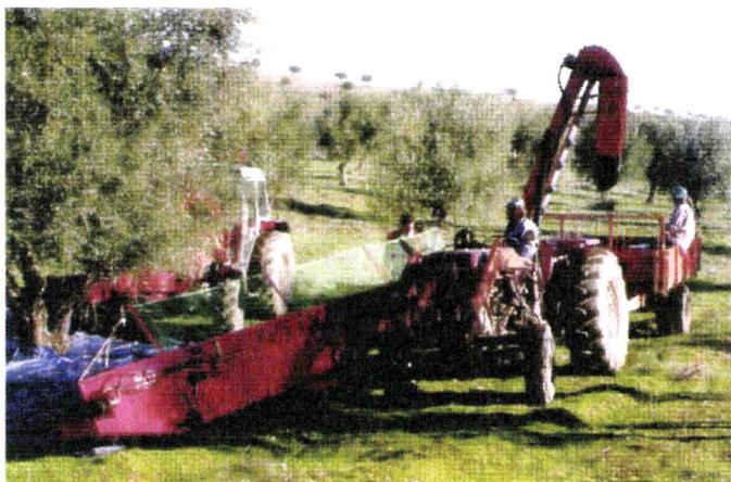
*Figura IV-21 - Enrolador de panos utilizado nos ensaios.*
