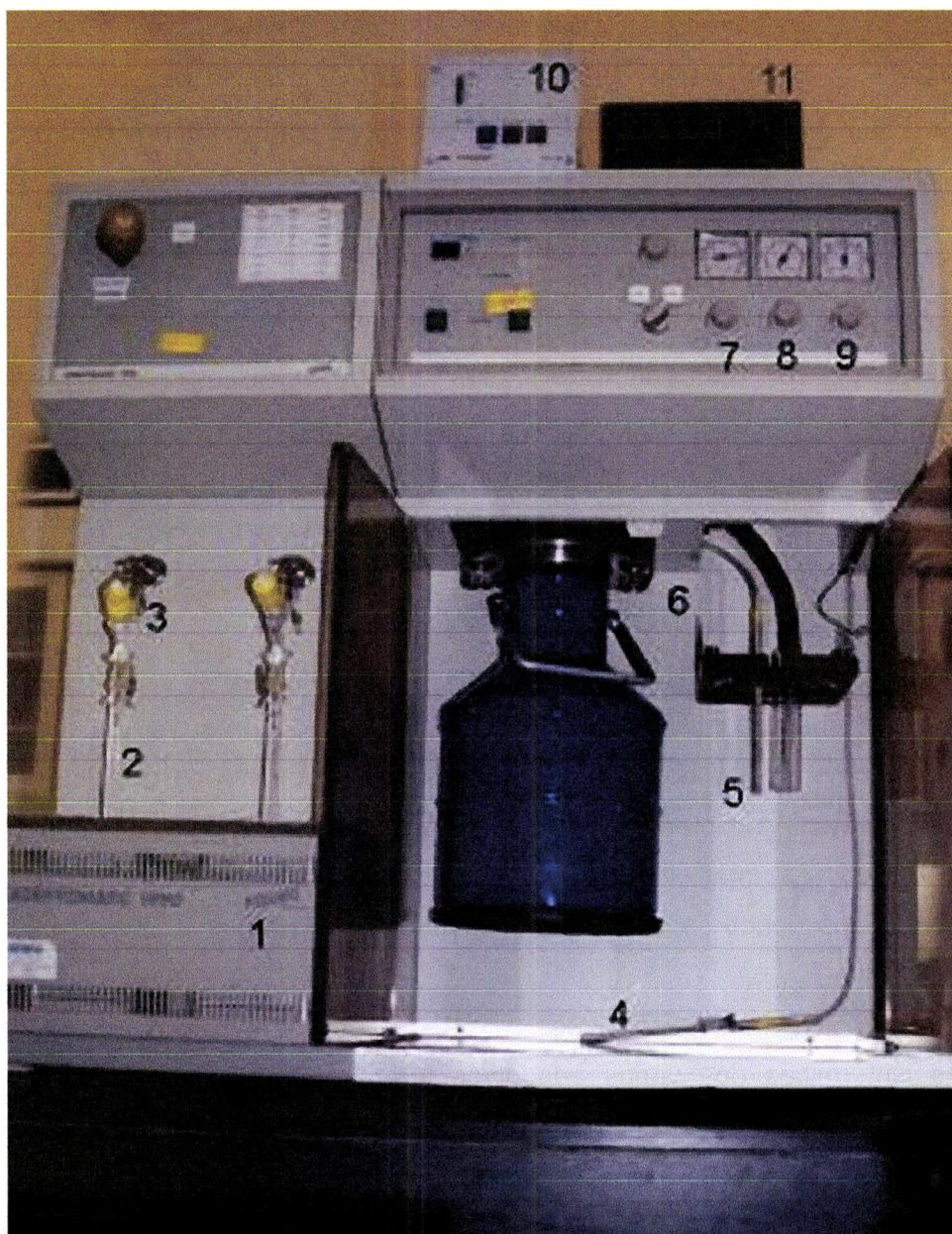
**Figura 2. 4** Sorptomatic 1990", aparelho onde se realiza a adsorção de  $N_2$  a 77 K.
