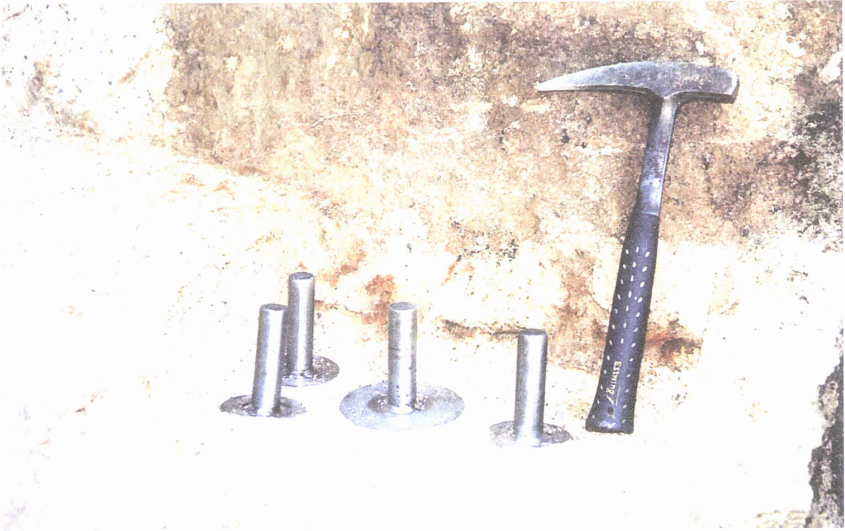
Figura 2.2 – Determinação dos pesos volúmicos in situ pelo método do extractor.
