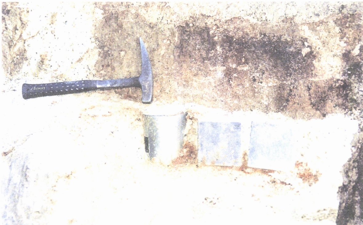
Figura 2.4 – Colheita de amostras indeformadas utilizando amostradores.
