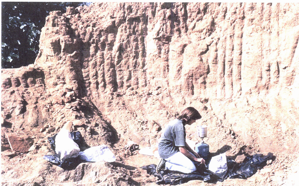
Figura 2.5 – Recolha e protecção de blocos do solo residual do granodiorito do Redondo (amostra 16 – Calado).
