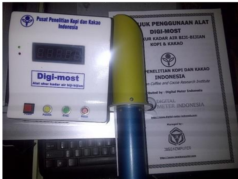
Figura 24 - Digi-most, aparelho para medição do teor de água
