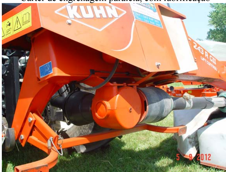
Carter de engrenagem cónica, com lubrificação
