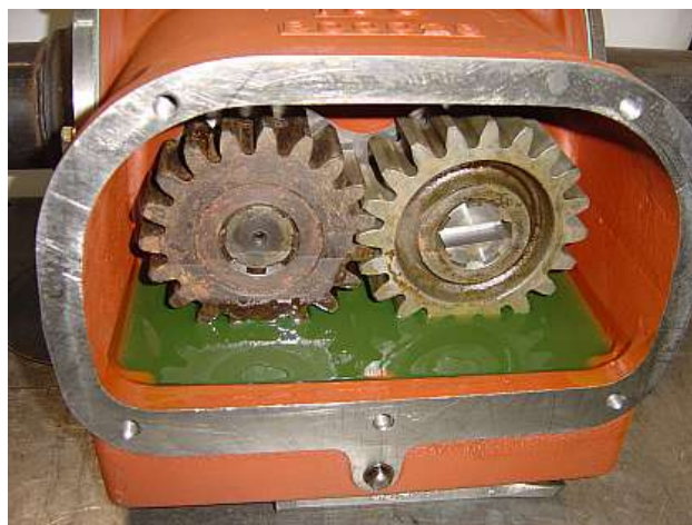
Engrenagem paralela, com dentado recto, em carter com lubrificação
