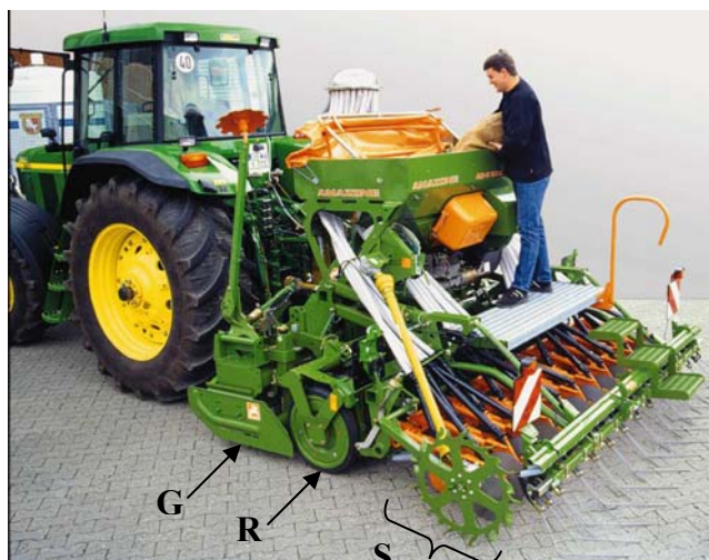
G- Grade rotativa; R – Rolo; - Semeador Ver funcionamento deste tipo de semeador em: http://info.amazone.de/DisplayFLV.aspx?id=6162
