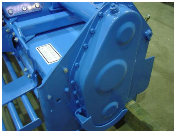
Carter de engrenagem paralela, com lubrificação
