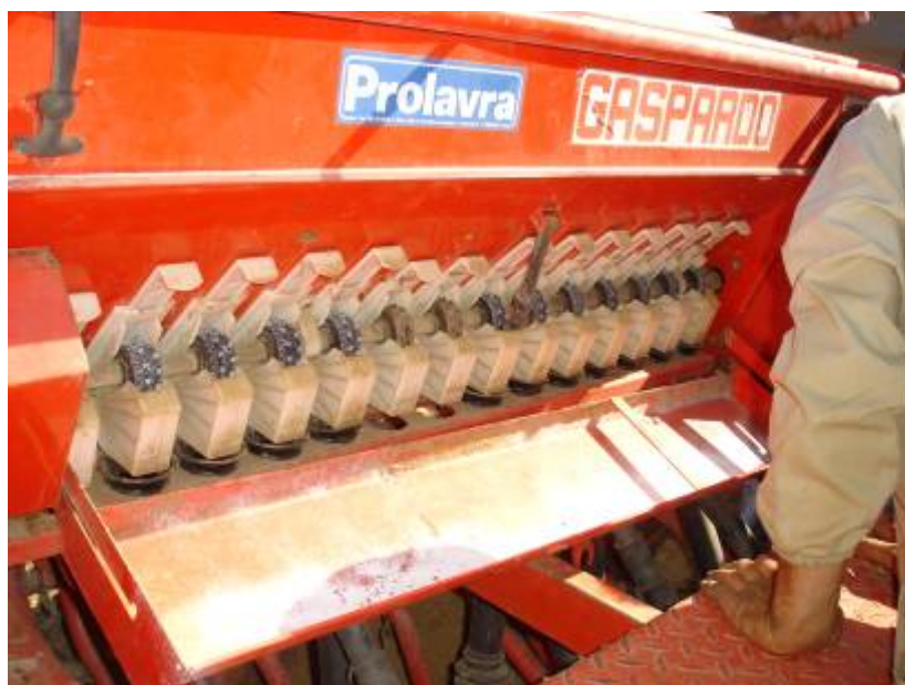
Veio de distribuidores de semente (cilindro dentado) num semeador de fluxo contínuo Gaspardo M300
