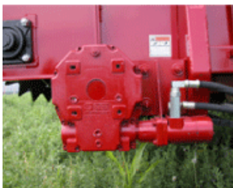
Carter de engrenagem sem-fim, com lubrificação
