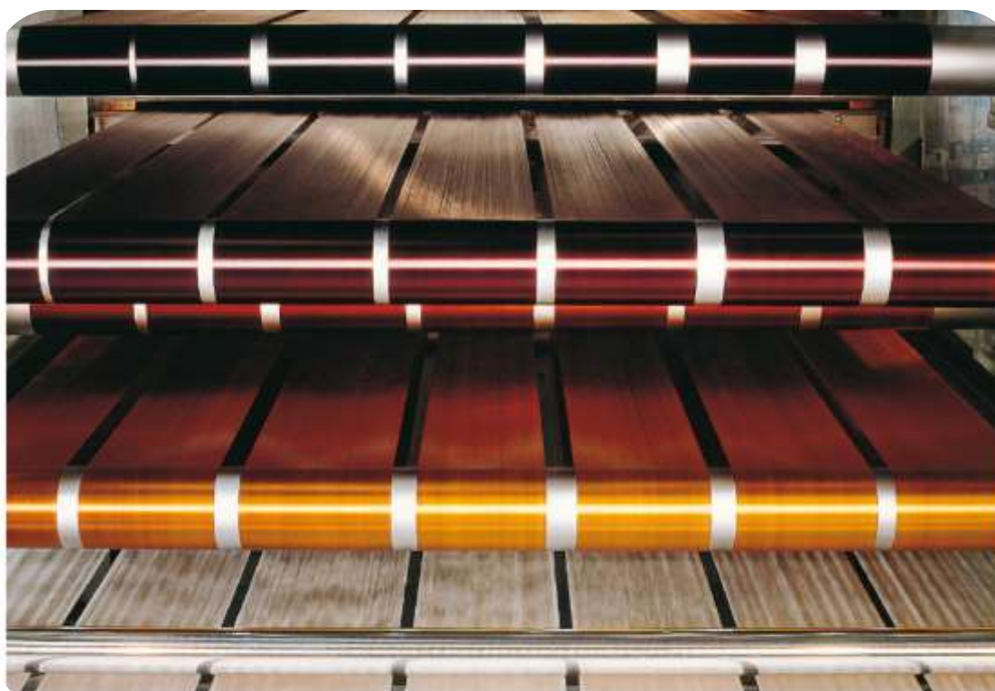
Figura 2.5 - Exemplo das etapas de oxidação de uma fibra oxidada [14]
