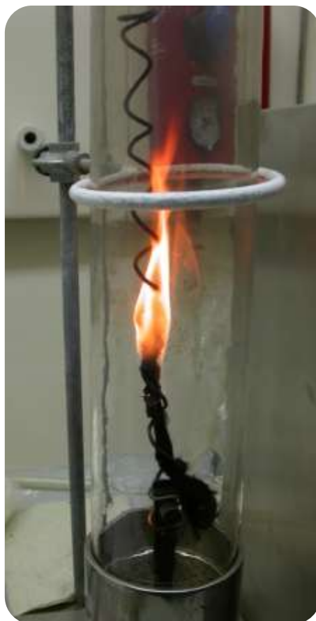
Figura 3.9 - Suporte de amostras utilizado no LOI para as fibras oxidadas
