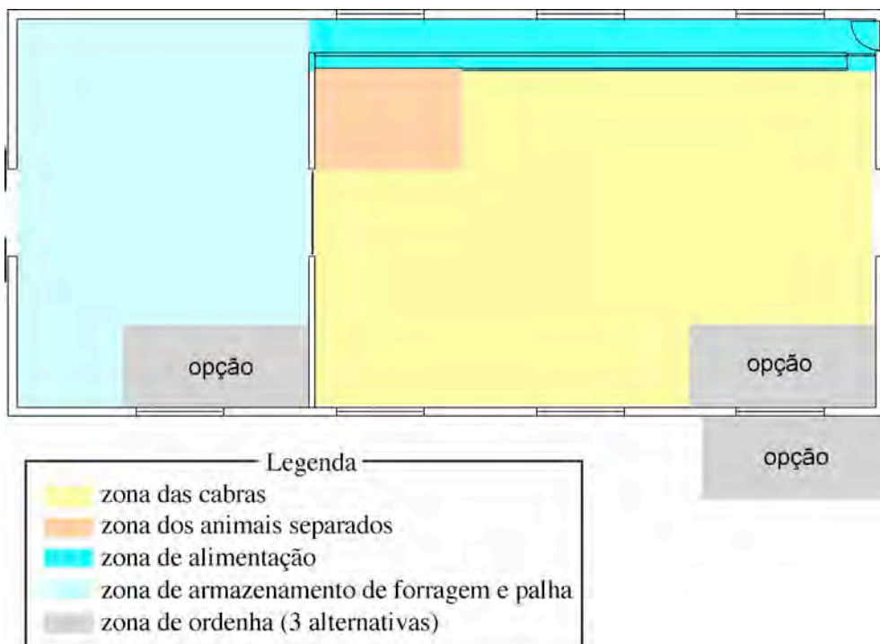
Figura 5.3 - Proposta de distribuição em planta para alojamento de caprinos. Modelo 1.
