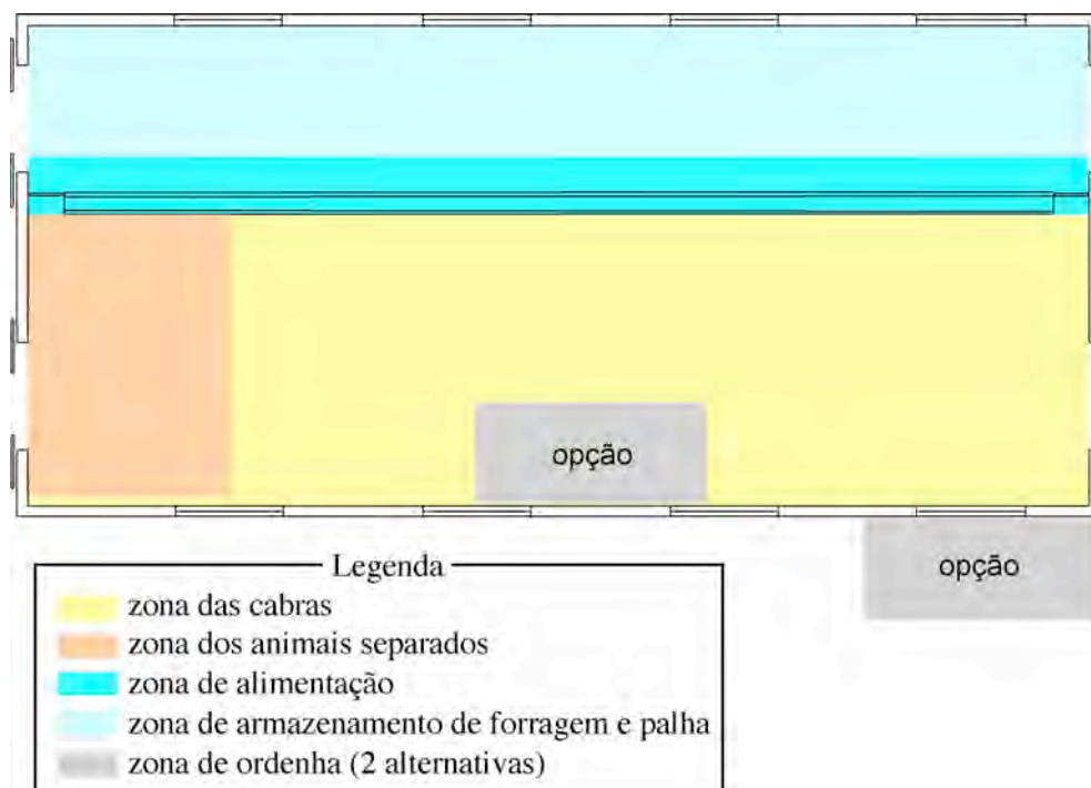
Figura 5.5 - Proposta de distribuição em planta para alojamento de caprinos. Modelo 3.
