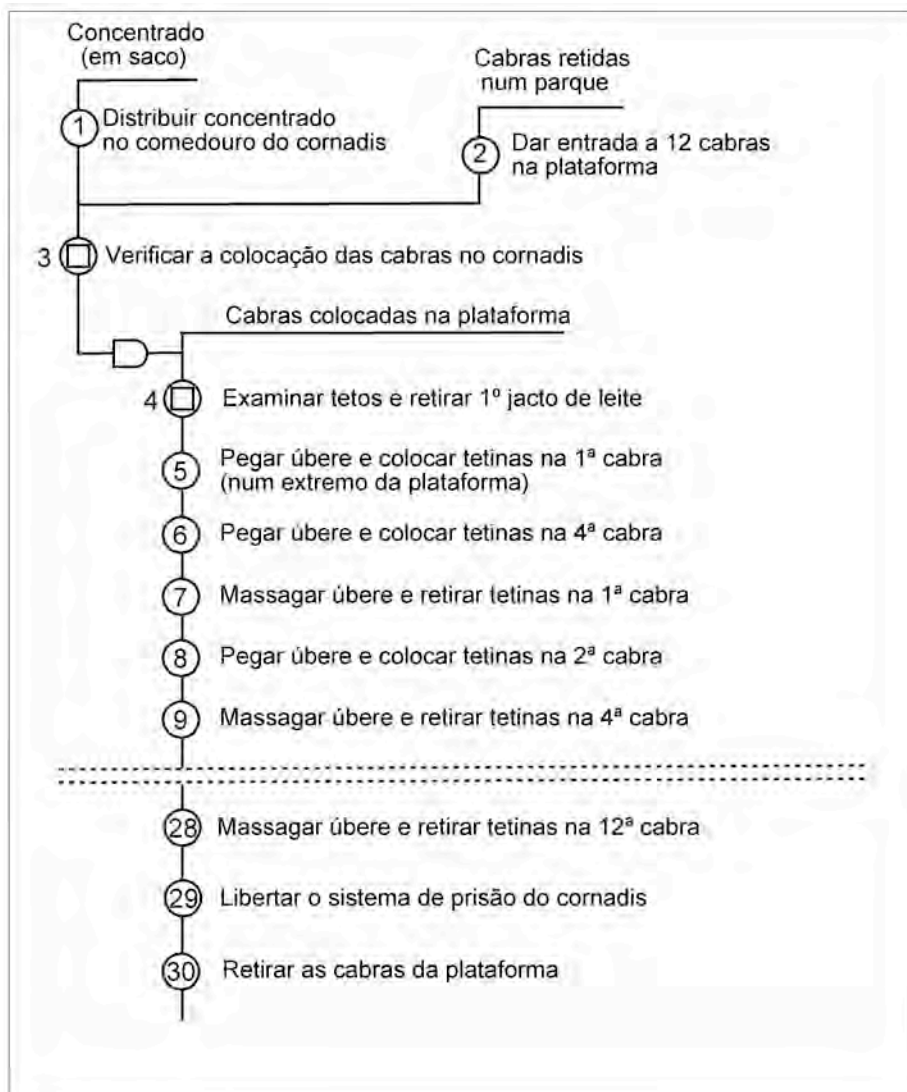
Figura 4.33 - Gráfico do processo do trabalho na ordenha de tipo mecânica com plataforma.
