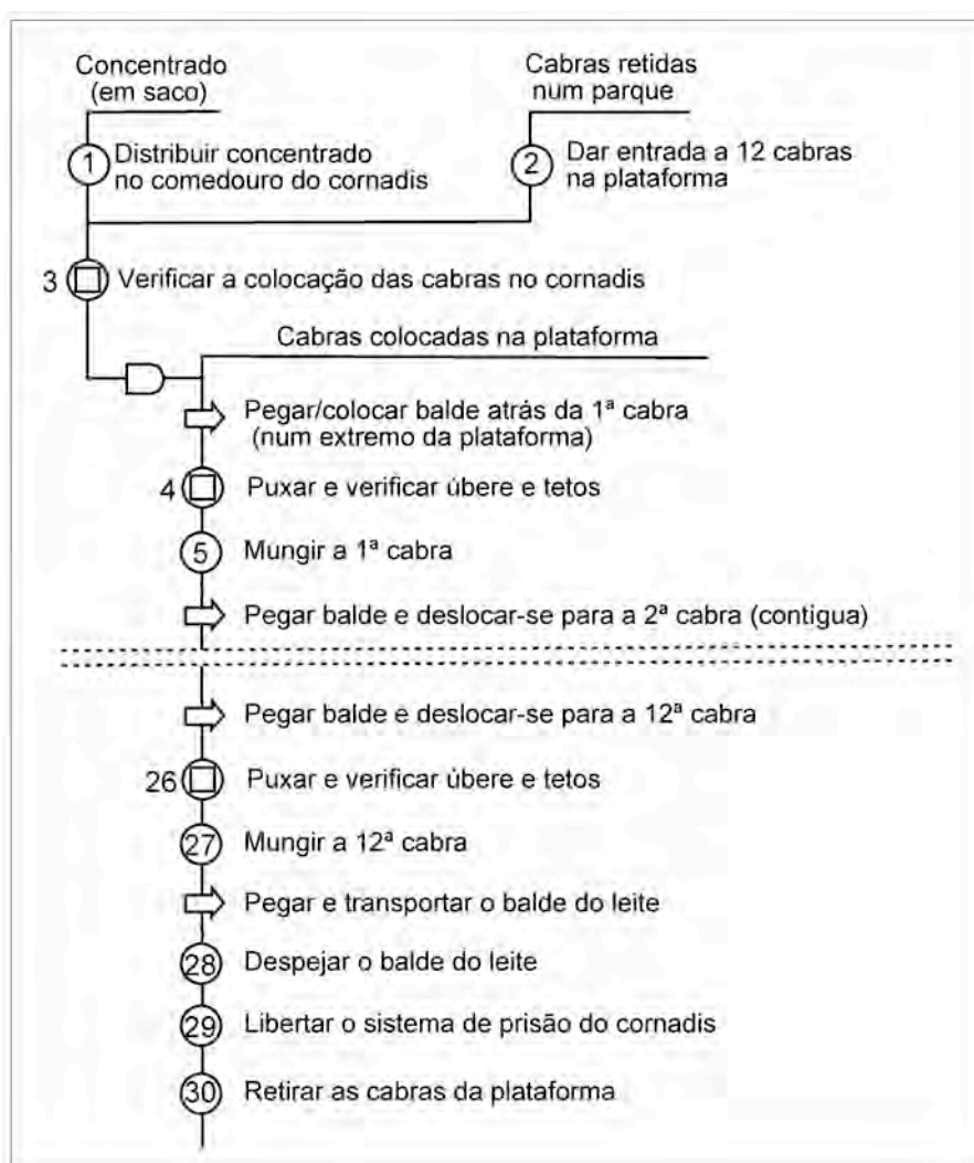
Figura 4.29 - Gráfico do processo do trabalho na ordenha de tipo manual com plataforma.
