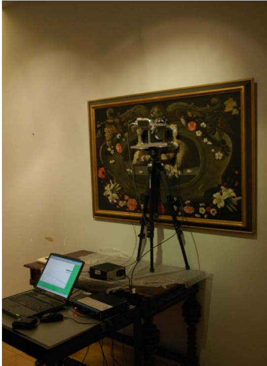
Ilustração 1: momento de análise por fluorescência de raios X no quadro Cordeiro Místico .
