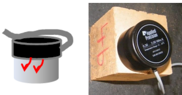
Figura 5.2 – Sonda superficial no provete de Solo
