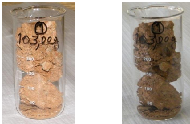
Figura 3.23 - Amostras do solo do ensaio Proctor antes de seco e depois de seco na estufa
