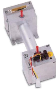
Figura 3.4 - Célula IR do sistema de detecção de carbono e enxofre
