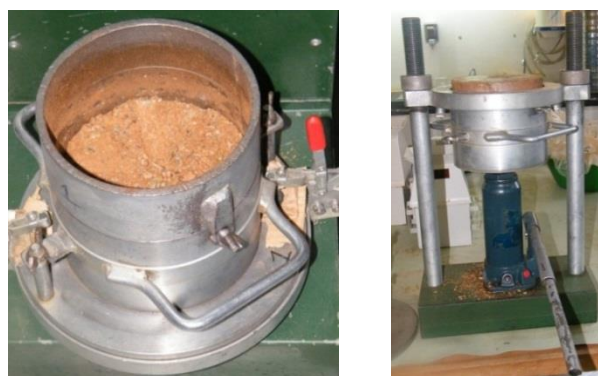
Figura 3.22 – Molde grande do Proctor e desmoldagem do molde após compactação
