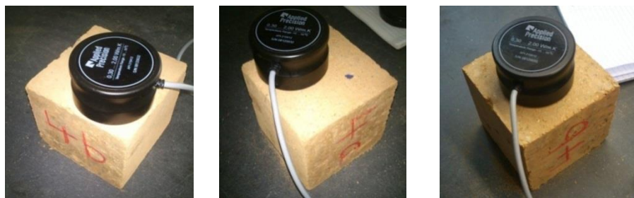
Figura 5.4- Determinação da condutibilidade térmica nas diferentes faces de um provete (face A, B e C).
