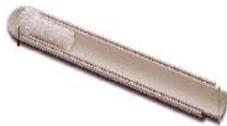
Figura 3.5 – Barcos para colocar as amostras 350 mg de solo
