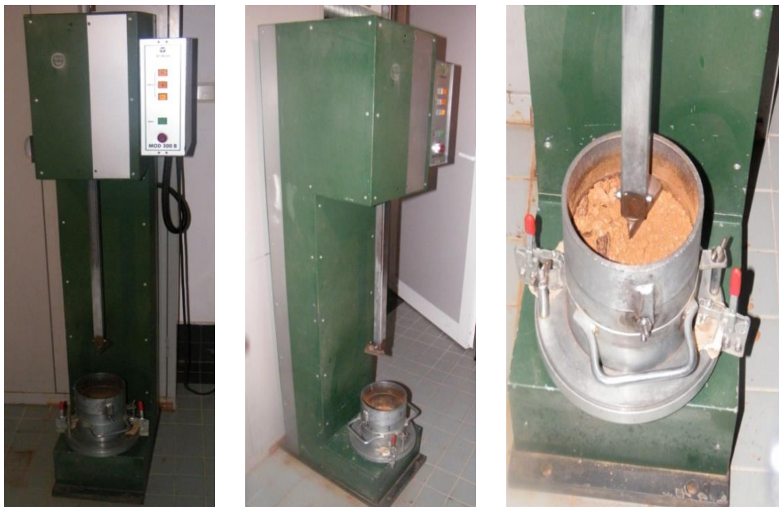
Figura 3.21 - Ensaio Proctor pesado molde grande (55 pancadas por camada)
