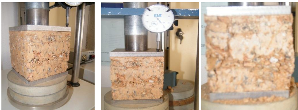
Figura 4.9– Proвете na fase de rotura
