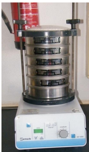
Figura 3.7 - Agitador com bateria de peneiros utilizados de malha grossa
