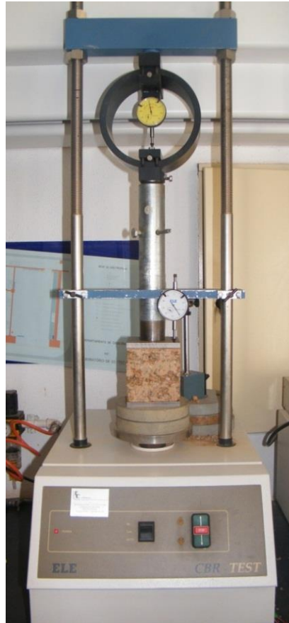
Figura 4.8– Ensaio de compressão uniaxial no equipamento CBR Test
