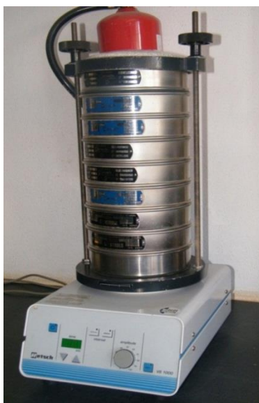
Figura 3.7 - Agitador com bateria de peneiros utilizados de malha grossa
