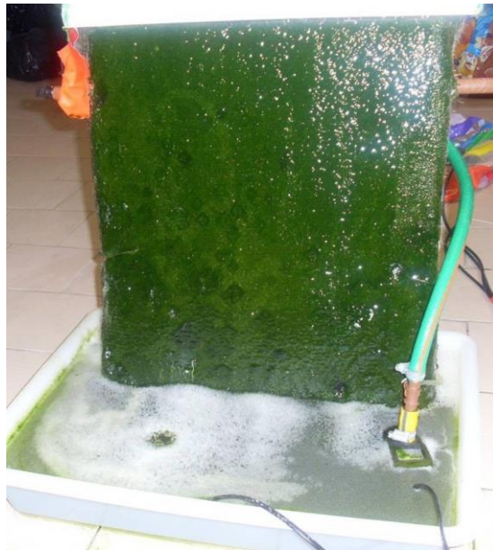
Figura 4. Detalle de biofilm de microalgas adherido sobre soporte. Fuente: GIR TADRUS
