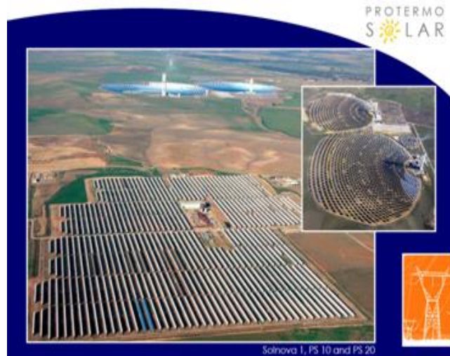
Figura 1 – Imagem promocional da associação espanhola Protermosolar, onde se podem ver três centrais CSP. Em primeiro plano uma central do tipo cilindro-parabólico - Solnova 1 - e em segundo plano duas centrais do tipo receptor central de torre - PS10 e PS20 (Crespo, 2009).
