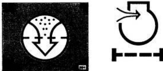
Exemplo de luzes indicadoras de colmatagem do filtro de ar
