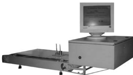
Fig. 3 - Fotografia da máquina dos sismos desenvolvida no CGE para o Centro Ciência Viva de Estremoz. À direita a caixa de controlo que encerra o sistema informático de aquisição, o sensor de força e o comando do motor.
