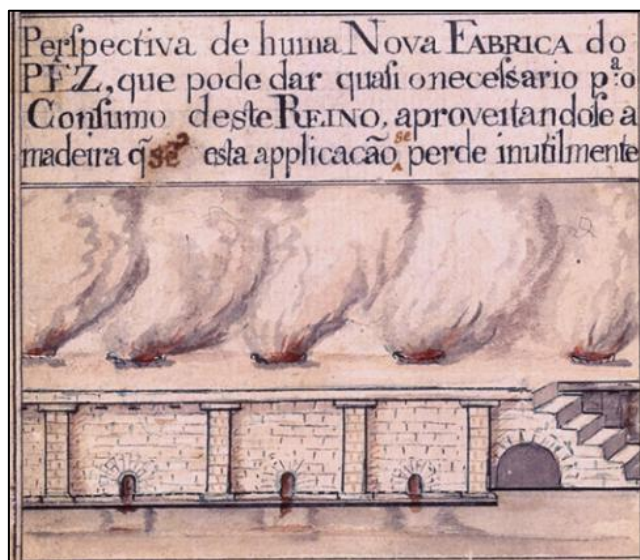
Imagem 1.6 - Modelo de forno de pez que se pretendia instalar em 1765
