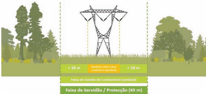
Fig. 2 – Limites da gestão e combustível nas linhas de transporte de alta tensão (Fonte: REN, 2016).
