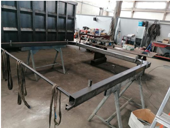
Figura 42-Molde para das estruturas tubulares em “U”
