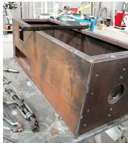
Figura 108-Construção da caixa
