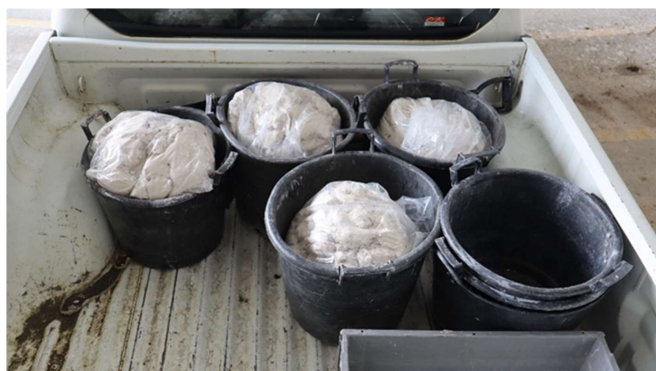
Fig. 5 – Amostras colhidas na Solancis, devidamente acondicionadas para transporte para o laboratório.
