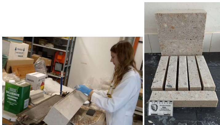
Figura 43 – Desmoldagem e provetes cortados destinados aos ensaios de resistência mecânica à flexão.
