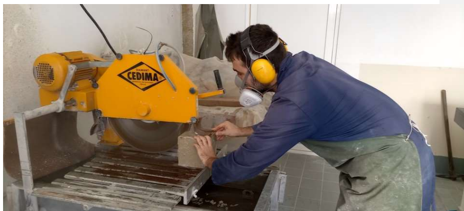
Fig. 37 – Corte com recurso a um charriot munido de disco diamantado.
