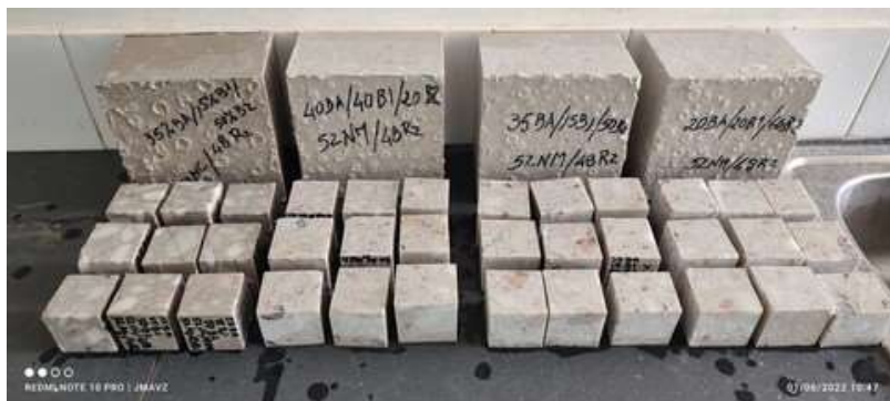
Figura 41 - Cortes executados a formulações para a produção de provetes cúbicos.
