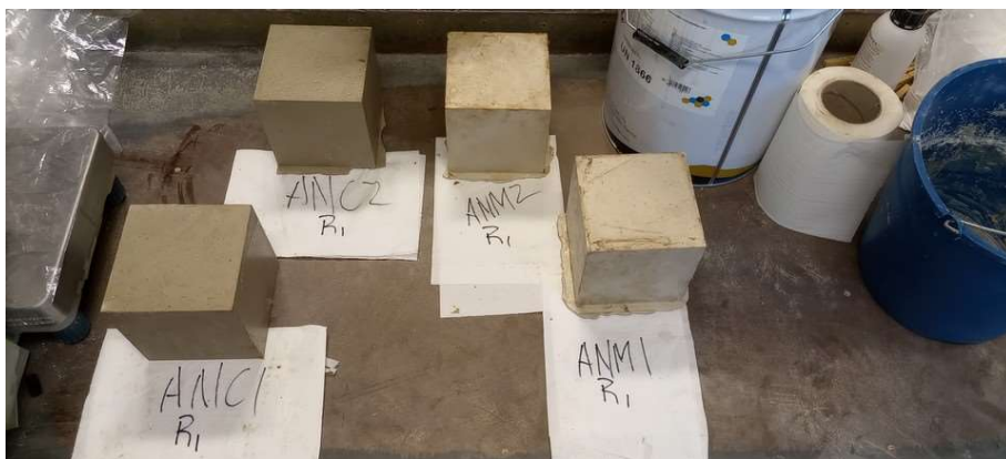
Fig. 36 – Cubos de ligante após desmoldagem.
