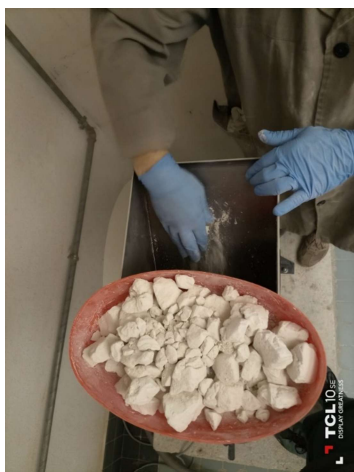
Fig. 16 – Pormenor dos fragmentos da nata em tabuleiro e introdução na torva do moinho.
