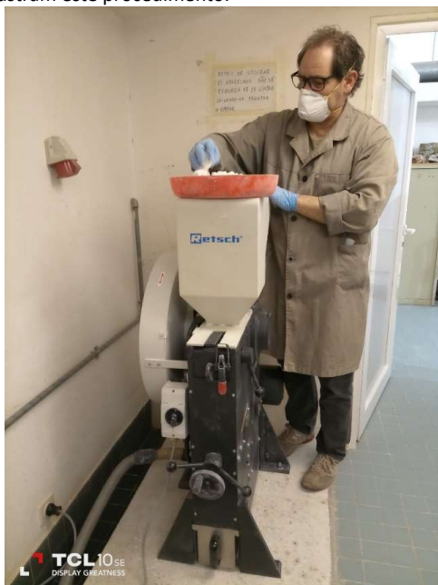
Fig. 15 – Moinho de maxilas e processo de desagregação das amostras.
