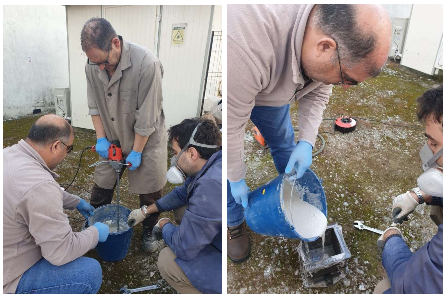
Fig. 34 – Mistura mecânica e deposição no molde da argamassa.
