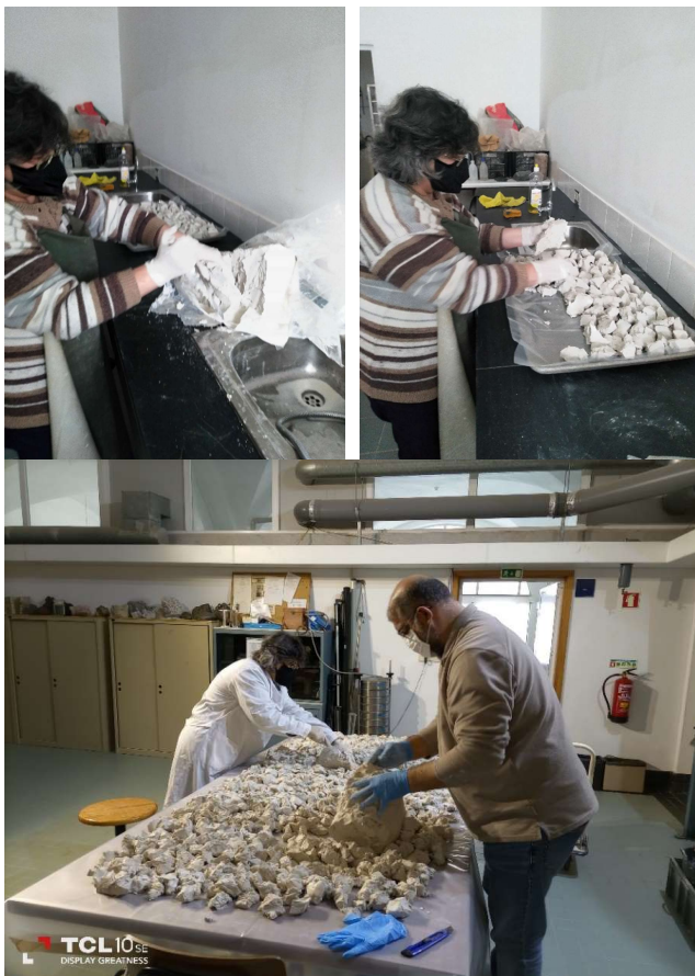
Fig. 13 – Corte de pedaços de pasta de nata e seu espalhamento para promover a secagem mais rápida à temperatura ambiente.
