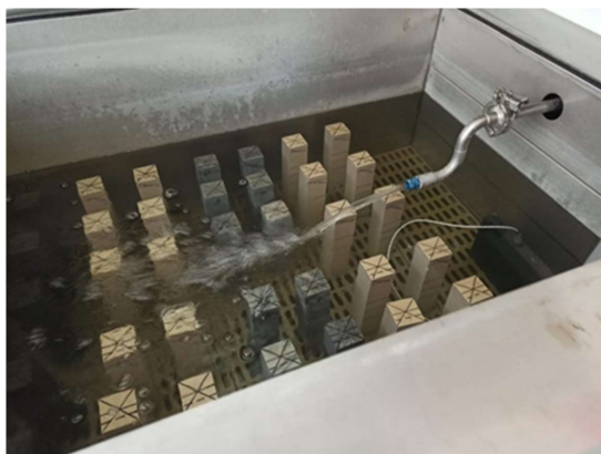
Fig. 45 – Exemplo da câmara utilizada para ensaios de gelo-degelo.
