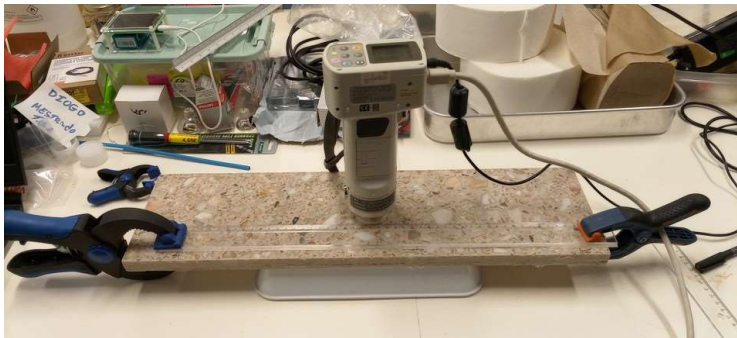
Fig. 51 – Ensaio de medição de cor com recurso a um colorímetro CR-400 da Minolta.
