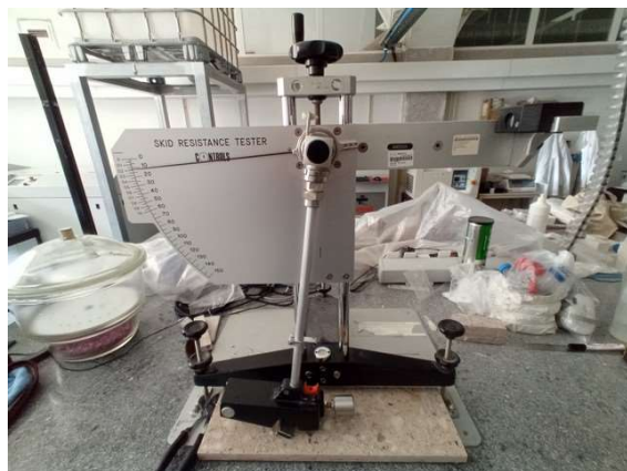
Fig. 46 – Pêndulo de atrito e ensaio de resistência ao escorregamento.
