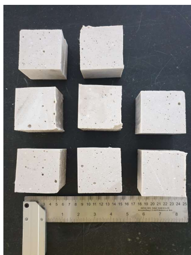
Fig. 38 – Provetes cúbicos de uma formulação de ligante para realização de ensaios de compressão uniaxial.
