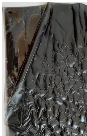
Figura 16- Descolamento do suporte e torna-se dobradiço. ©Joana Saial
