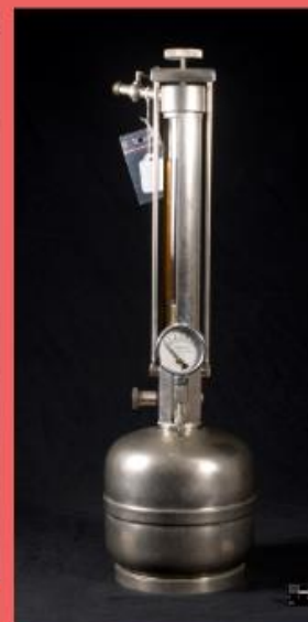
Compressor para injeção de contraste radio-opaco para obtenção de Aortografias (Invenção de Prof. Reynaldo dos Santos), © José Fadalla-MUHNAC
