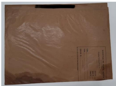
Figura 21- Envelope de papel danificado com libertação de líquido na emulsão. ©Joana Saial
