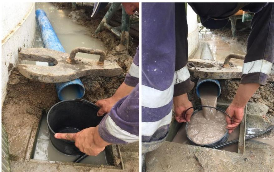
Figura 13. Medição do caudal durante a captação da água, utilizando um balde de 10 l.
