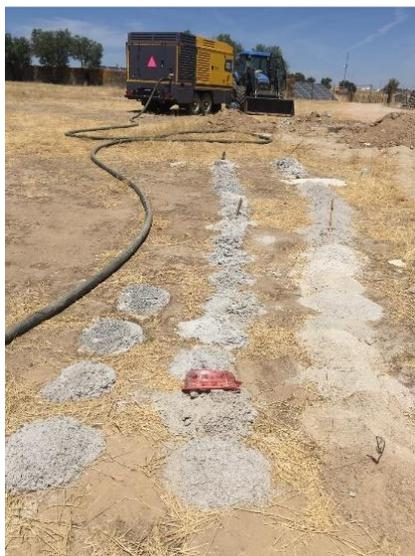
Figura 7. Amostras dos testemunhos de sondagem do furo de pesquisa da Quinta da Casinha.
