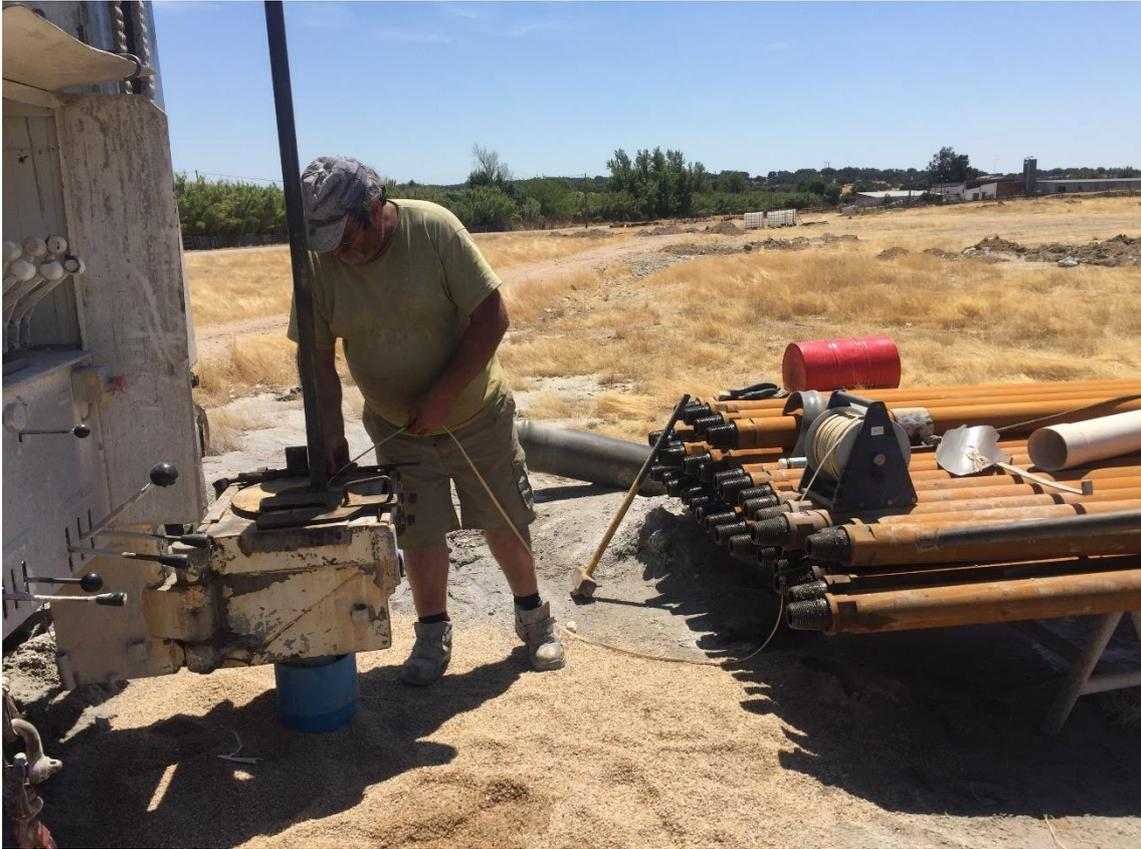
Figura 11. Medição do NHE da captação.
