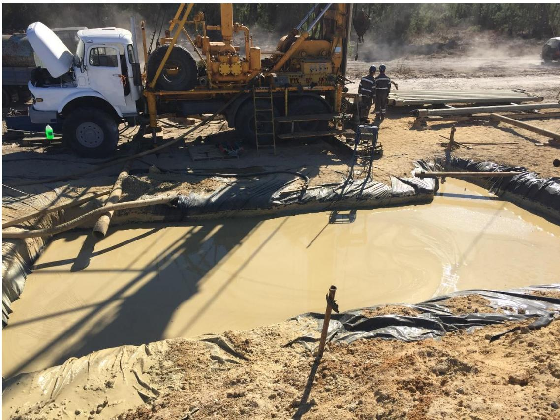
Figura 13. Máquina de perfuração inversa, com o tanque de lamas em primeiro plano.
