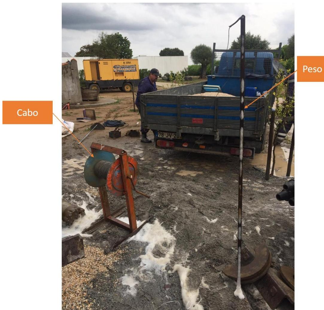
Figura 11. Sonda de profundidade, com cabo de aço de 50 m.
