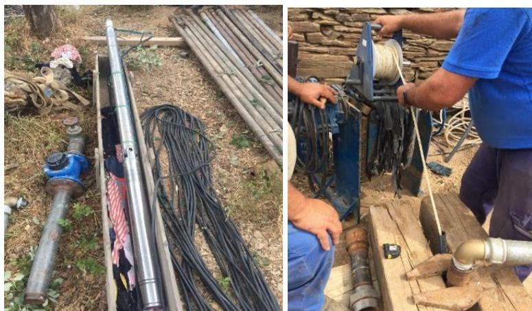
Figura 14. Bomba submersível (à esquerda) e mangueira e sonda métrica (à direita).
