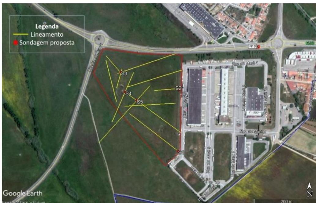
Figura 5. Fotointerpretação dos lineamentos na zona de estudo, com indicação dos pontos de sondagem (S1 a S5).
