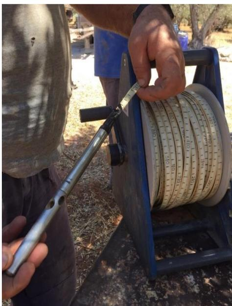
Figura 5. Sonda hidrométrica.
