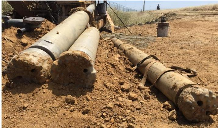
Figura 6. Martelos pneumáticos utilizados durante a sondagem (da esquerda para direita são ilustrados os martelos de 12”, 9” e 8”) constituídos por bits de carbonato de tungsténio e orifícios para entrada de fluídos.
