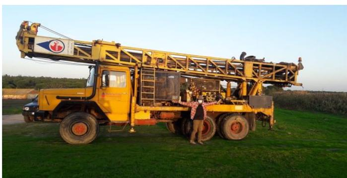
Figura 17. Equipamento de sondagem mecânica utilizado para a sondagem à rotação com circulação inversa de lamas.
