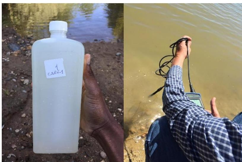
Figura 2. Colheita de uma amostra de água na ribeira (à esquerda), amostra já recolhida em frasco de plástico (centro), e medição da condutividade elétrica na água de uma albufeira (à direita).
