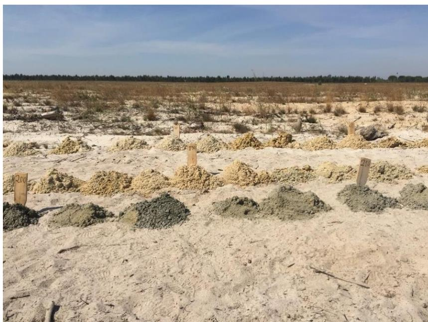
Figura 9. Testemunhos da sondagem (amostras das rochas) da sondagem S2.
