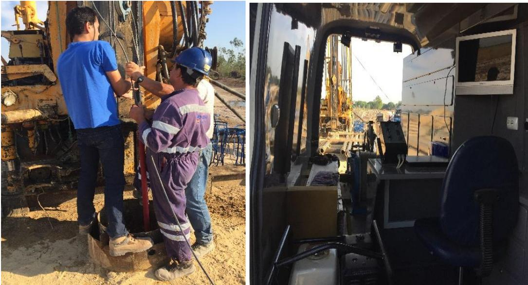
Figura 11. Inserção da sonda multiparamétrica (à esquerda) e cabine de comando das diagrfias (à direita).
