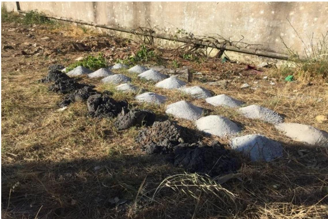
Figura 8. Amostras de rocha da sexta sondagem, transformada em captação.
