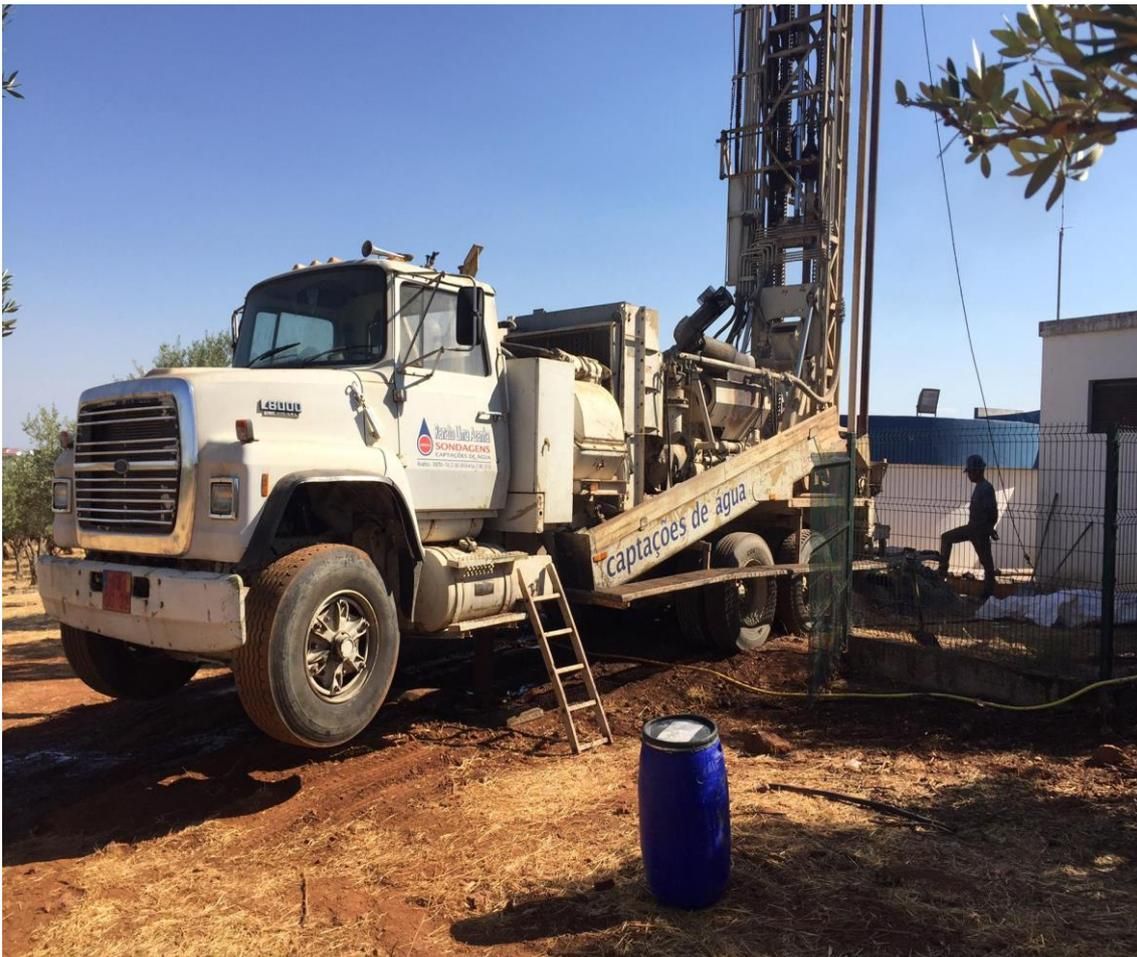
Figura 10. Máquina de perfuração da empresa Renato Azenha a realizar uma sondagem à rotopercussão.
