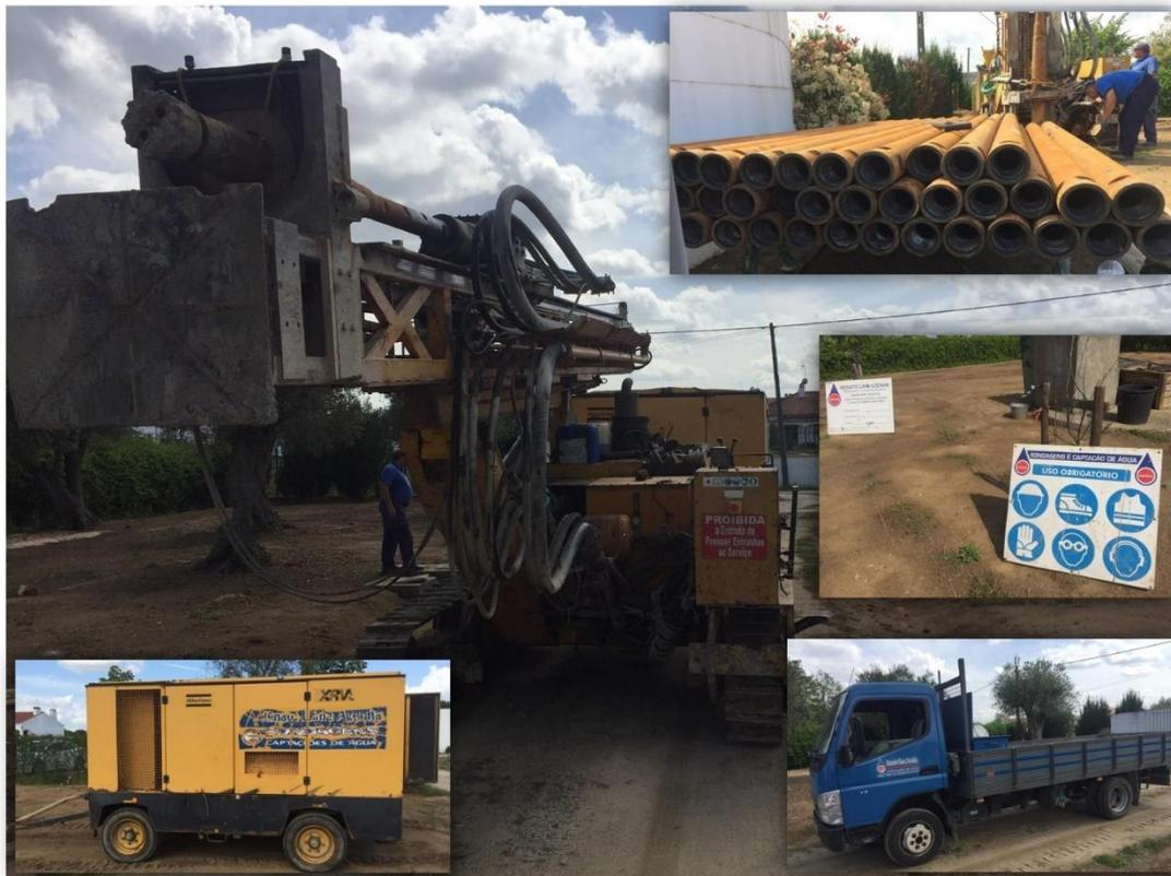
Figura 5. Equipamentos e ferramentas prontas para executar a sondagem (a imagem maior ilustra a máquina de sondagem, os pormenores à volta da imagem maior mostram as varas de perfuração, as placas com sinais de uso obrigatório de EPI e informação sobre a licença, uma carrinha do tipo Mitsubishi Canter para transporte de material para a zona de perfuração, e por fim, o compressor de ar, isto visto a partir do canto superior direito ao canto inferior esquerdo, respetivamente).
