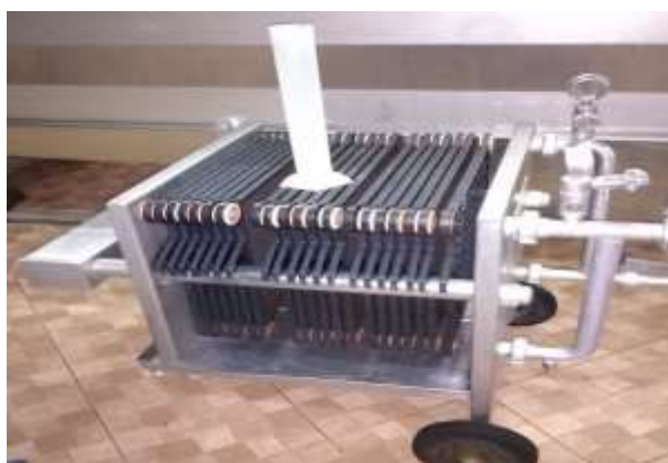
Figura 13. Filtro de placas utilizado para filtrar o vinho antes do engarrafamento (Fonte próprio)
