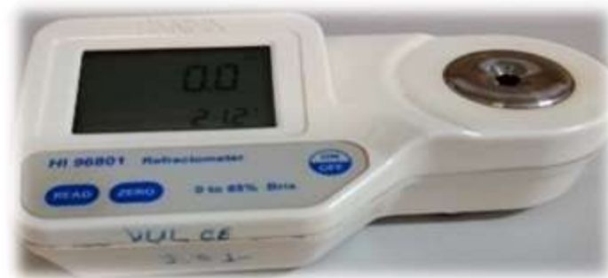
Figura 5. Refratómetro usado para determinação do teor de sólidos solúveis em ° Brix.
