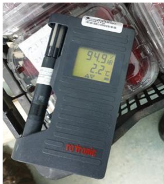
Figura 3.9 - Dispositivo de registo de humidade e temperatura, “data logger” da marca Rotronic
