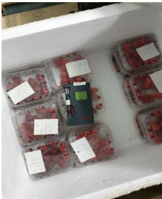
Figura 3.8 - Caixa de isolamento térmico com cassetes e “data logger”
