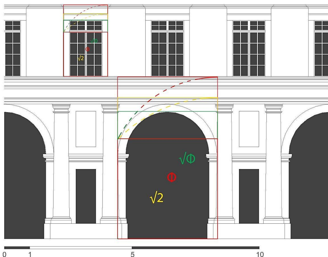
Fig. 132- Estudo proporcional do alçado interpretativo do claustro Torriano do Mosteiro de Santa Clara-a-Nova 228 (metros).
