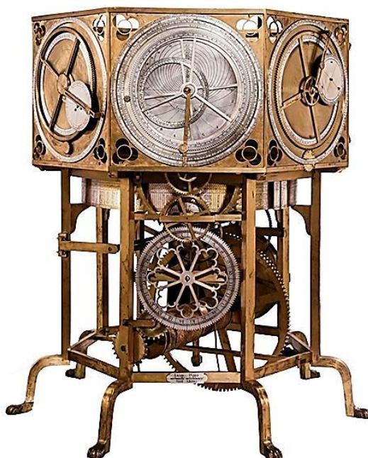
Fig. 81 – Astrario segundo o modelo de Giovanni Di Dondi 172 , reconstrução de Luigi Pippa (1961-1963), Museu de Ciência e Tecnologia de Milão. Fonte: https://artificiodejuanelo.org/los-referentes/#iLightbox[gallery_image_1]/1
