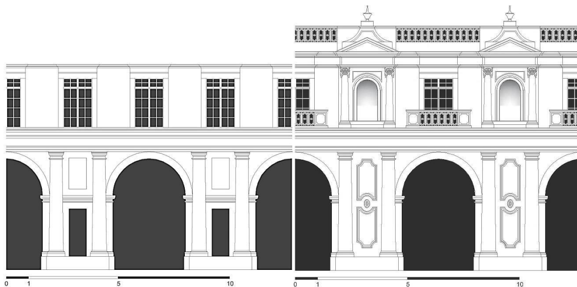
Fig. 130- Alçado interpretativo das alterações tipológicas do claustro (metros): à esquerda, segundo a descrição do projeto original 226 ; e à direita, após a reforma barroca. Pedro Tavares, 2016.
