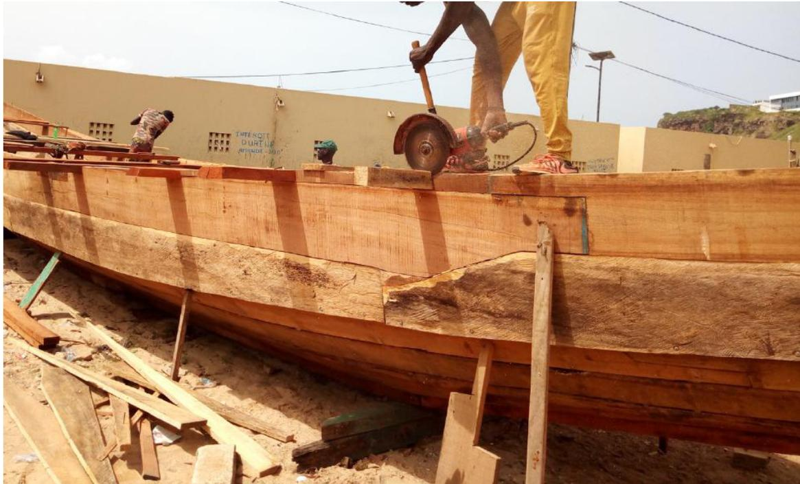
*Figure 26: finition des flancs de l'embarcations (Photographie P. L. DIOP, 2019)*
