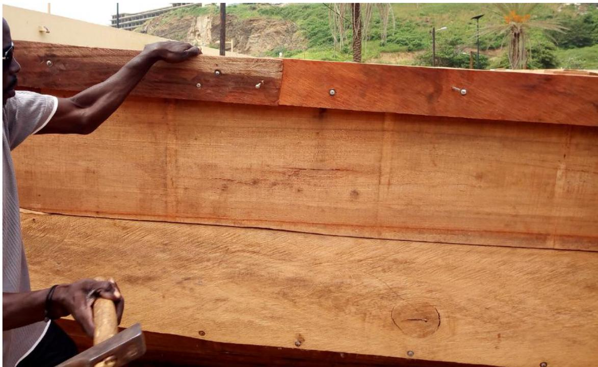
*Figure 27: finition des flancs de l'embarcations (Photographie P. L. DIOP, 2019)*
