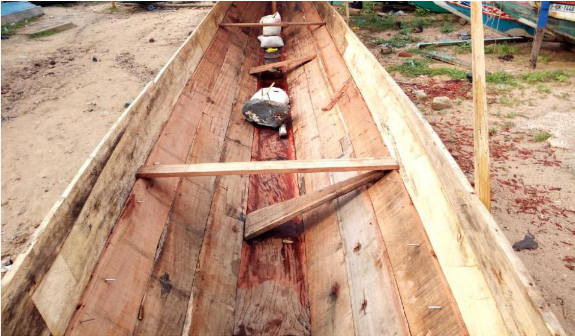
*Figure 21: vue de l'intérieur du cloutage de la partie supérieure (Photographie P. L. DIOP, 2019)*
