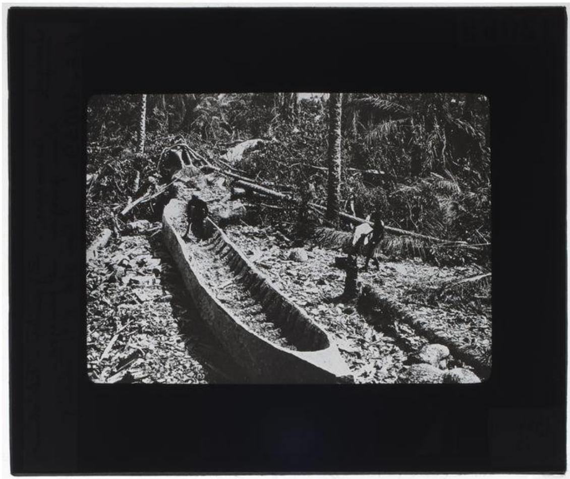
*Figure 12: Creusement d'une pirogue monoxyle ; Source : Musée du Quai Branly, numéro de gestion : PVoo68717 ; description « Sénégal Casamance R. D. Zinguinchor, fabrication d'une pirogue en fromager 1933 – 1934. Photographie : Constant Tastevin*
