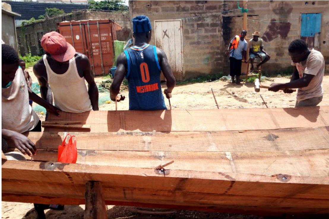
*Figure 19: fixation des planches par martelage (Photographie P. L. DIOP, 2019)*
