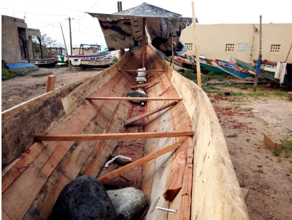
*Figure 20: cloutage de la partie supérieur (Photographie P. L. DIOP, 2019)*
