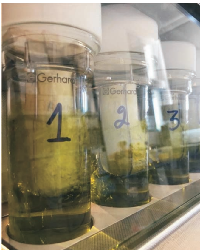
Fig. 42 – Amostras no Soxtherm em funcionamento.
