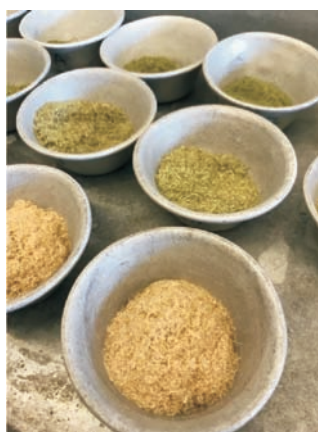
Fig. 39 – Preparação dos cadinhos com as diferentes amostras para colocação na estufa.
