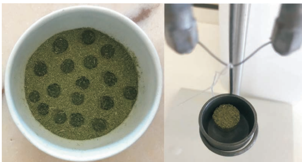
Fig. 43 – Preparação da amostra para colocação no calorímetro.
