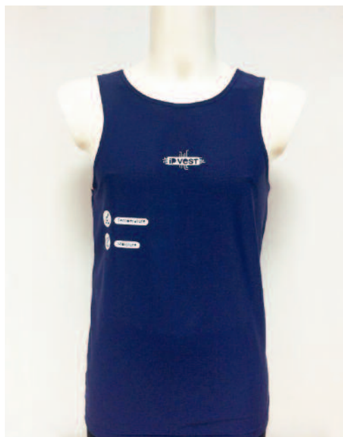
FIG. 2: Fotografia de um protótipo resultante do projeto iP VEST, no qual vemos uma estrutura têxtil com capacidade de adquirir dados como temperatura e humidade.
