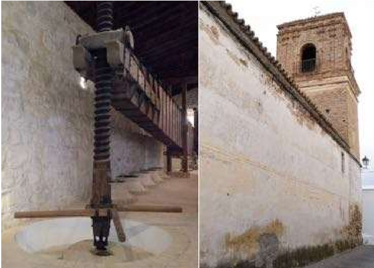
Fig. 3.- Izquierda: Baeza (Jaén). Prensa de viga. Museo de la cultura del olivo. Hacienda “La Laguna”. Fotografía de Sheila Palomares Alarcón, 2013 / Derecha: Carmona (Sevilla). Torre de contrapeso de una prensa de viga y quintal. Antiguo molino de la Romera. Fuente: fotografía de Sheila Palomares Alarcón, 2017.
