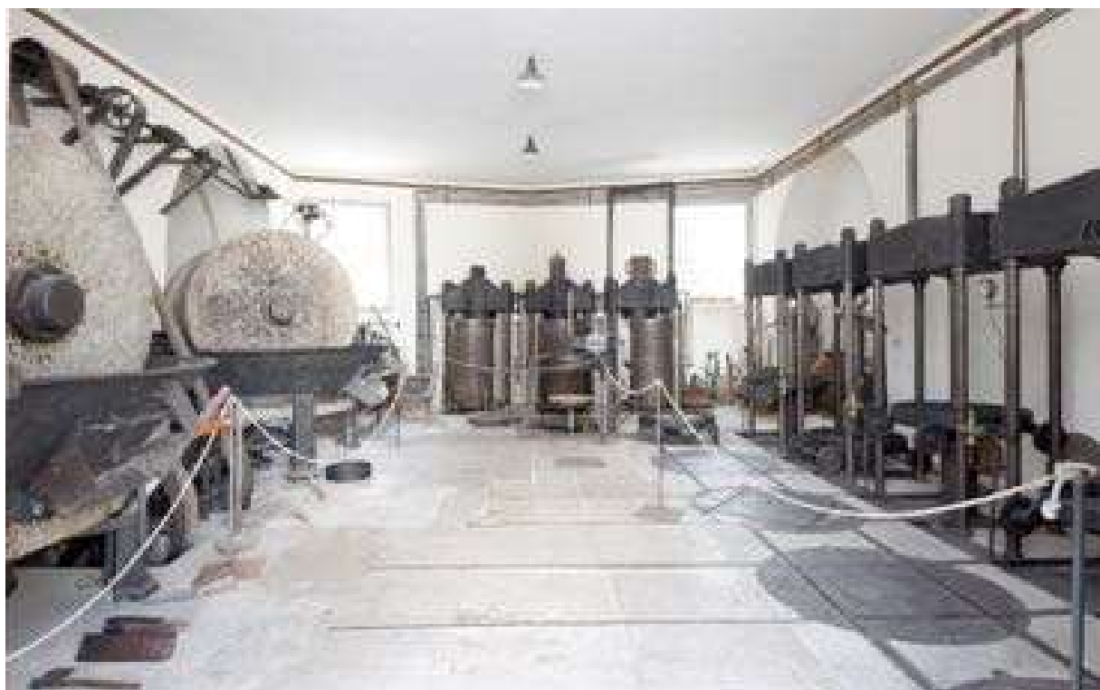
Fig. 2.- Andria (BT). Almazara de la finca Terre di Traiano. Dos molinos con dos piedras (izquierda), cuatro prensas hidráulicas de cuatro columnas a torre abierta (derecha) y tres prensas hidráulicas con jaula metálica. Propiedad de N. Spagnoletti Zeuli. Fuente: fotografía de Antonio Monte, 2017.
