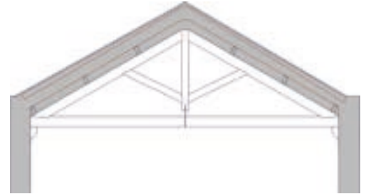
227. Corte esquemático da estrutura da cobertura presente.
