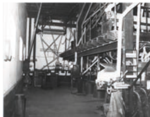
204. Espaço e maquinaria destinados à limpeza, ao descasque e ao branqueamento de arroz.
