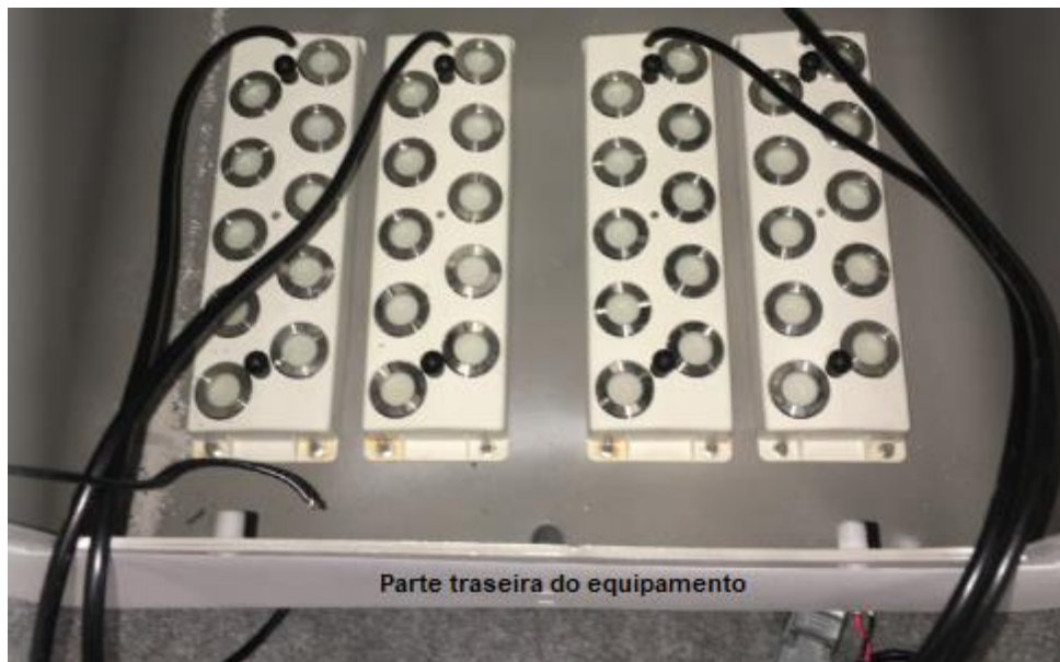
Figura 15. Representação do esquema de montagem dos atomizadores.
