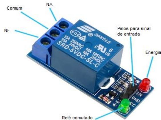
Figura 25. Saídas para ligações dos fios de um relé.
