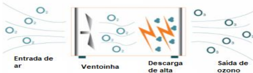
Figura 7. Funcionamento do equipamento de descontaminação por ozono.
