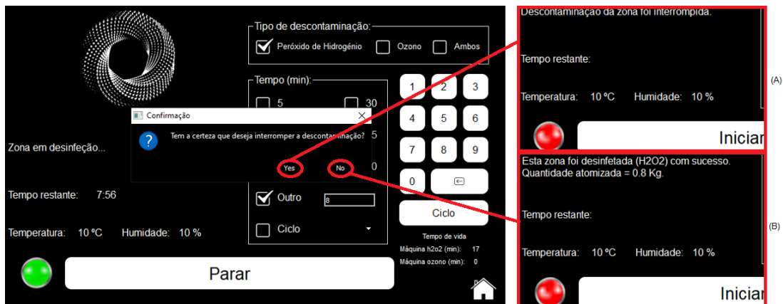
Figura 47. A - Representação da interrupção do ciclo. B – Representação do fim do ciclo.
