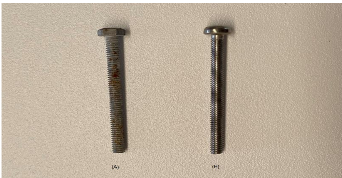
Figura 68. Ação do peróxido de hidrogénio no aço. A - Solução à 50%. B - Solução à 35%.
