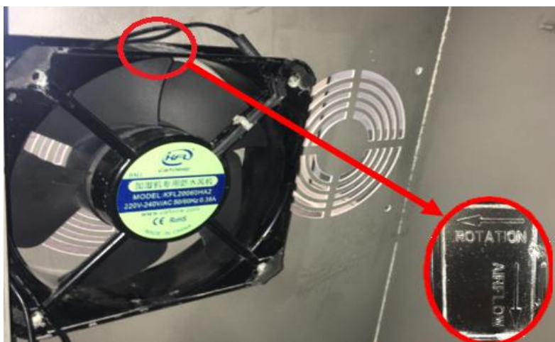
Figura 20. Representação da montagem das ventoinhas.
