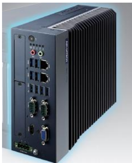
Figura 24. Computador industrial, MIC-770 H310
