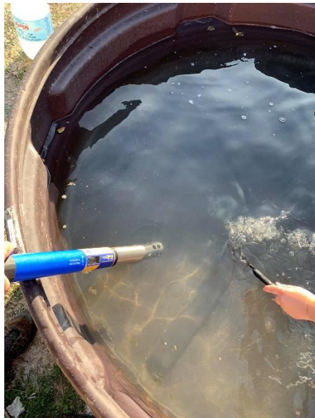
Figura 15. Medição da salinidade através de uma sonda Troll 9500 Profiler XP
